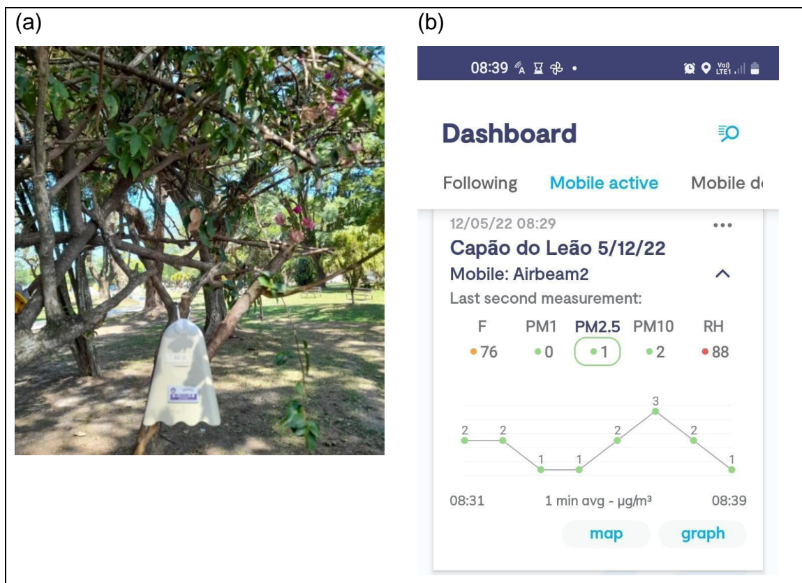
Figura 15 - (a) sensor AirBeam2 alocado junto a planta Bougainvillea glabra (b) dados de monitoramento em tempo real no aplicativo AirCasting.
