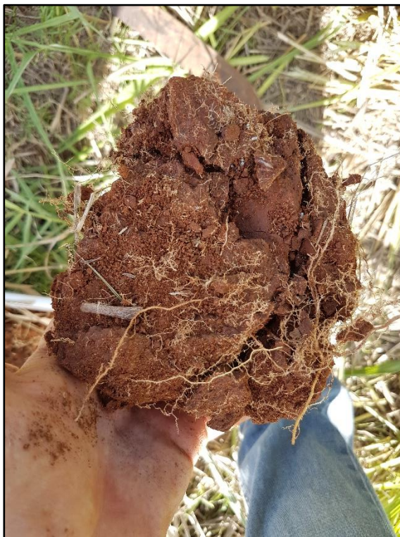
Figura 9: Amostra de agregados com presença de torrões, sub-angulares com necessidade de esforço para quebra. Fonte: Autor
