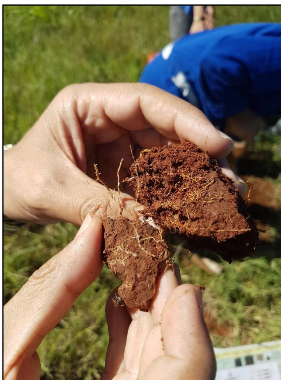
Figura 8: Amostra de agregado do solo mais firme, angular e resistente a quebra. Fonte: Autor
