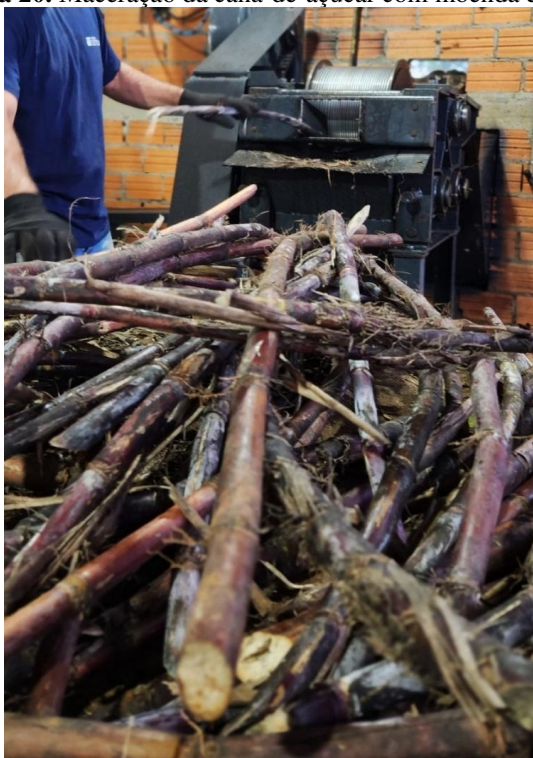
Figura 20. Maceração da cana-de-açúcar com moenda elétrica.
