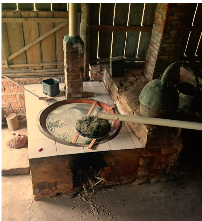
Figura 26. Purificação artesanal do caldo de cana-de-açúcar.
