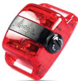
Figura 21. Acelerômetro ActiGraph ® – modelo wGT3X-BT .
