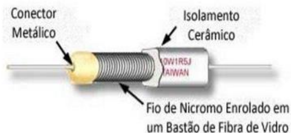
Figura 82 - Construção de resistor de fio
