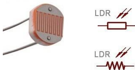
Figura 95 - LDR e seus simbolos esquemáticos
