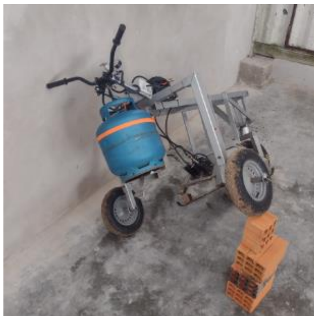
Figura 55 - Teste realizado para determinação do tombamento oblíquo do protótipo 2.
