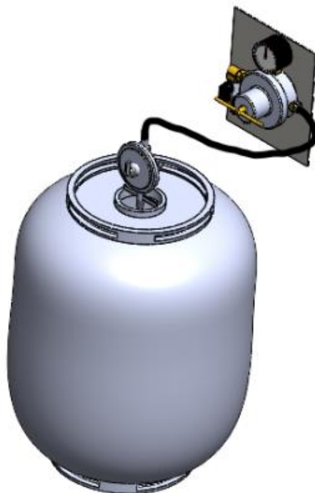
Figura 23 – Perspectiva isométrica do sistema dosar gás, do protótipo 2
