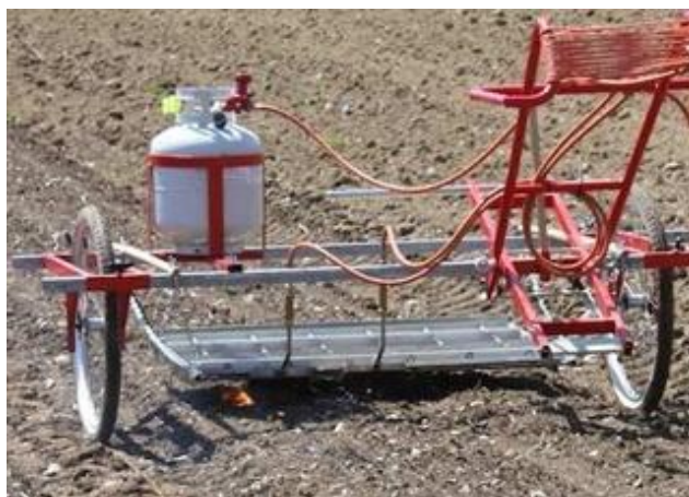
Figura 4 - Mecanismo de tração humana utilizado para aplicação de calor. Fonte: GALLANDT, 2010.
