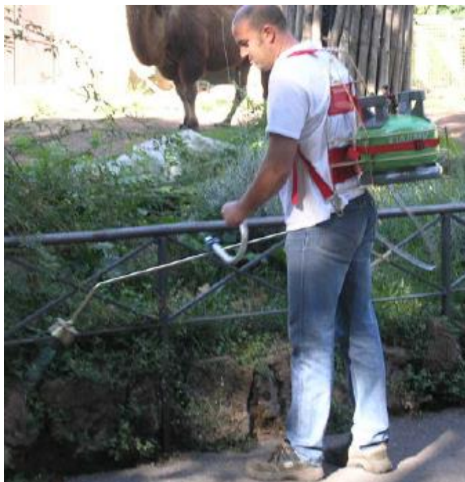
Figura 8 - Equipamento de aplicação de calor manual costal. Fonte: MIGONZZI GROUP, 2017.
