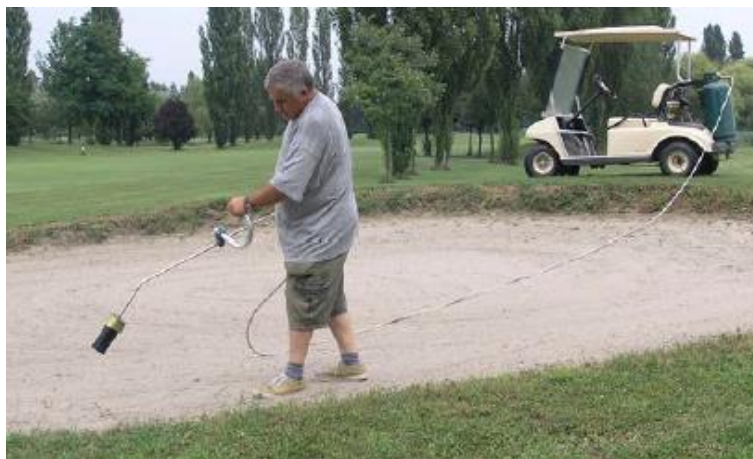
Figura 10 - Equipamento de aplicação de calor com GLP transportado por carro motorizado. Fonte: MIGONZZI GROUP, 2017.
