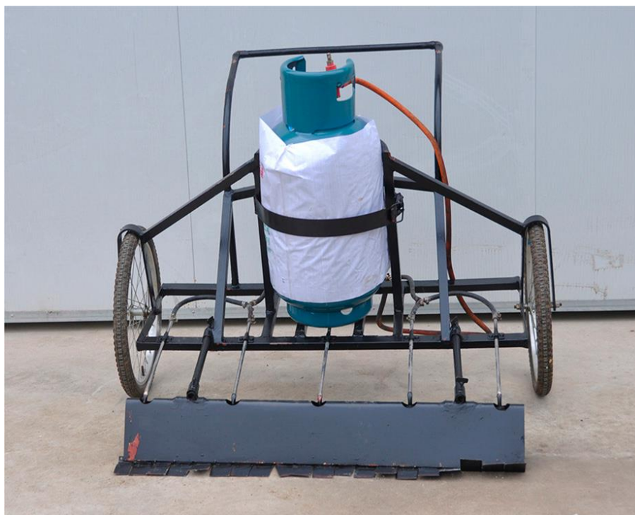
Figura 11 - Equipamento de tração humana para aplicação de calor com GLP. Fonte: GUO et al., 2019.
