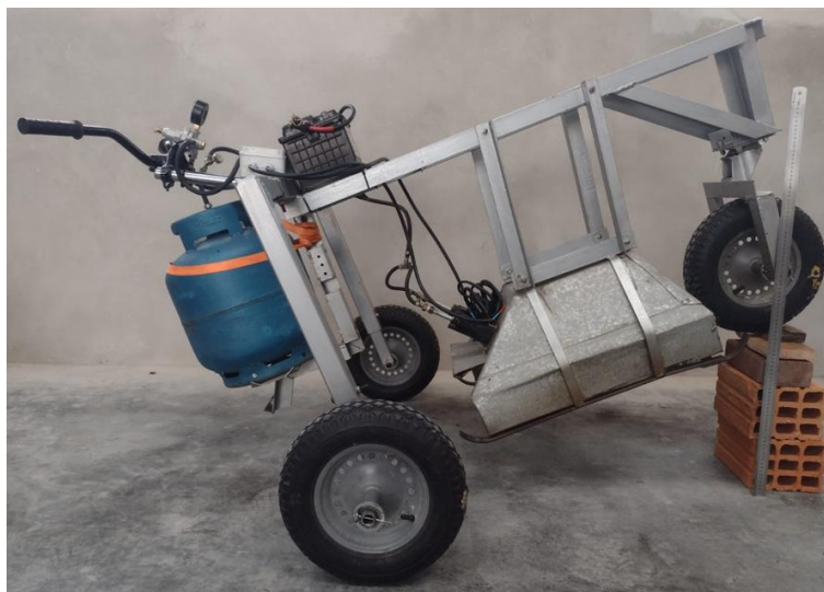
Figura 53 - Teste realizado para determinação do tombamento longitudinal para trás do protótipo 2.
