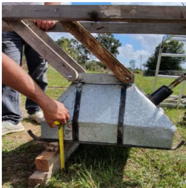
Figura 28 – Determinação da altura da campânula com relação ao solo, para ultrapassar um obstáculo.
