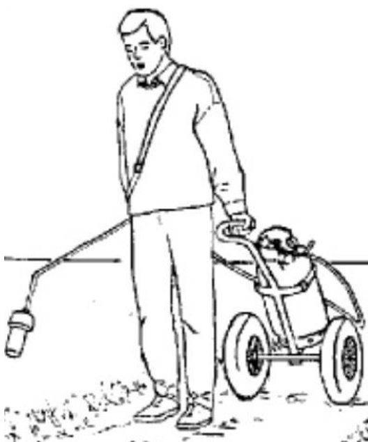
Figura 9 - Equipamento de aplicação de calor com GLP transportado por carrinho manual. Fonte: MIGONZZI GROUP, 2017.
