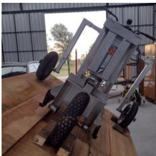
Figura 54 - Teste realizado para determinação do tombamento lateral do protótipo 2.
