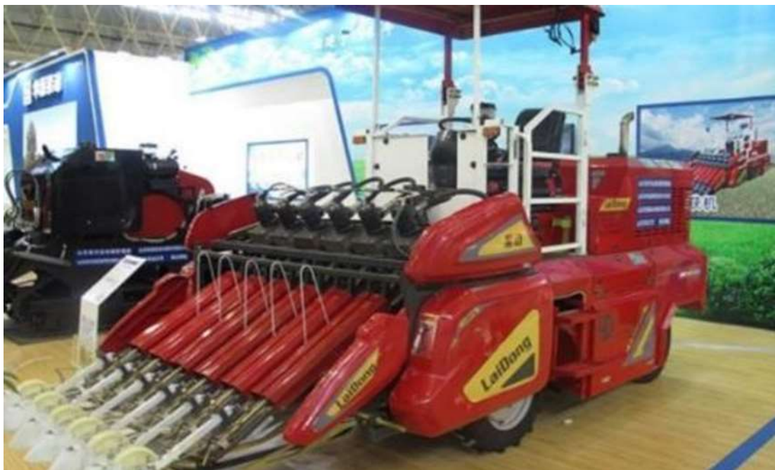
Figura 11. Colhedora de alho autopropelida 4DS-6. Fonte: ZHU et al., 2018.
