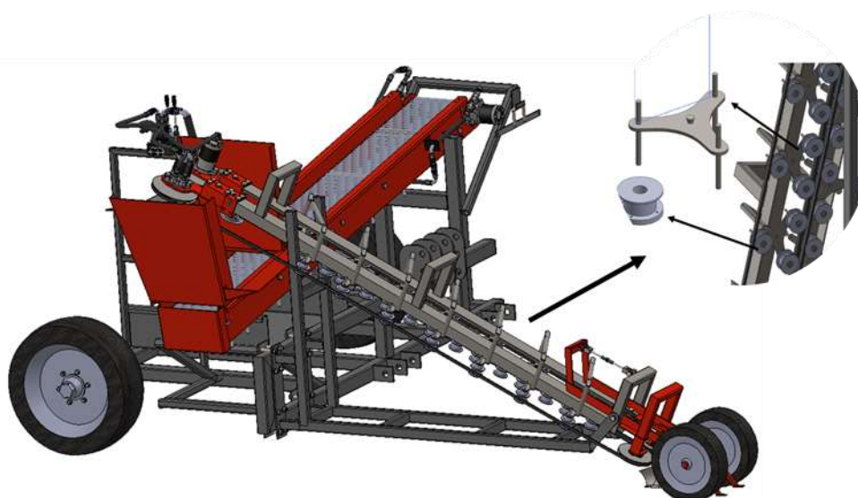
Figura 63. Máquina colhedora de alho com sistema de pressão nas correias. Fonte: AUTORA, 2022.
