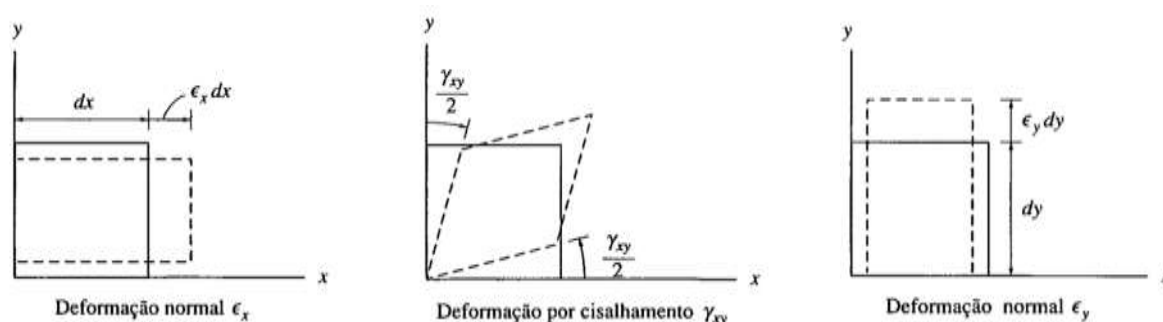
Figura 17. Estado do plano de deformações de material. Fonte: HIBBELER, 2010.
