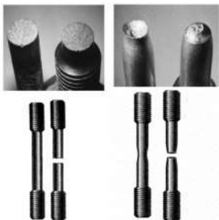
Figura 19. Superfície característica dos diferentes tipos de fraturas. Fonte: ASHBY; JONES, 1996.
