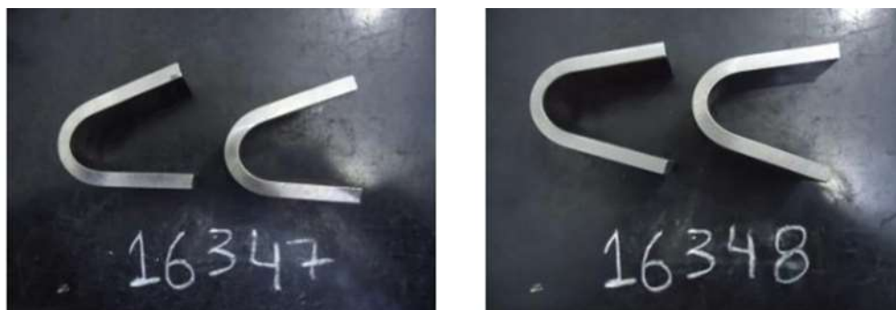
Figura 23. Amostra ASTM A131 DH36 (16347) e ASTM A36 (16348) conformadas a frio. Fonte: GHENO; SILVA, 2015.
