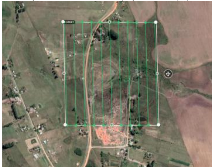
Figura 4: Plano de voo criado no programa DroneDeploy
