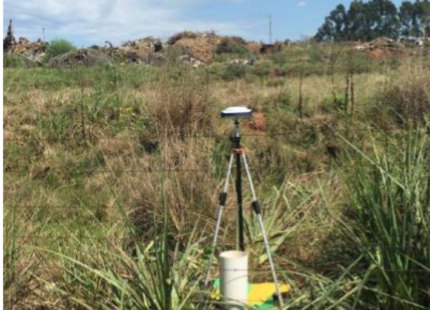
Figura 2: Rastreamento de ponto de controle com receptor GNSS
