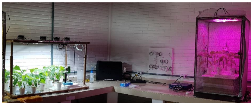
Figura 5 - Disposição dos sistemas de iluminação usados nos experimentos. A esquerda o sistema de iluminação adaptado para o crescimento das plantas e a direita, o sistema de iluminação da gaiola de Faraday para aferição das medidas elétricas.
