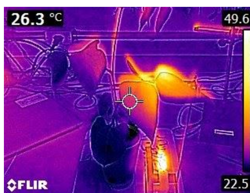
Figura 8 - Imagem da câmera termográfica durante a aplicação de uma chama por 20s a uma distância de 10cm da folha local
