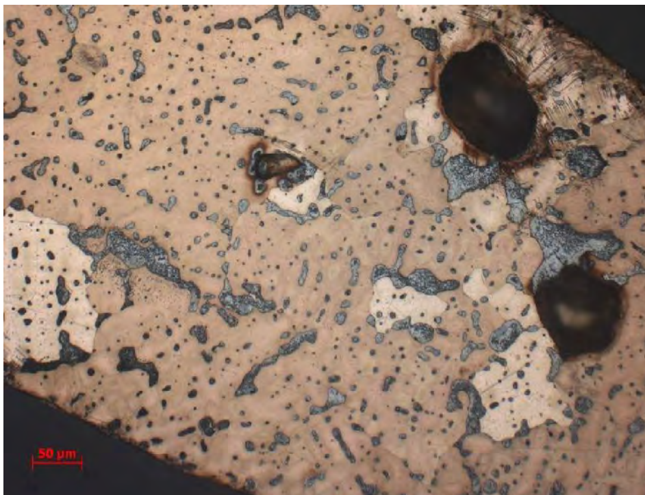
Figura 10: microestrutura do bronze antigo observada no microscópio ótico (Univerddidade de Genova)
