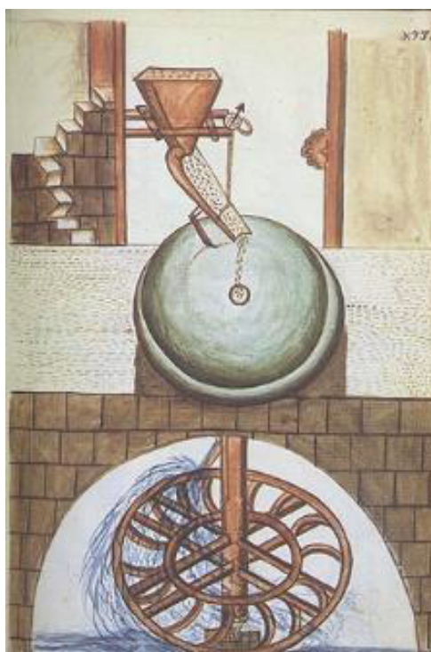
Figura 1: molino hidráulico de rodezno del virreinato del Perú (siglo XVIII). Vista interna.
