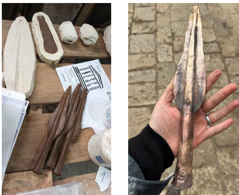
Figura 11: realização de modelos em cera para o processo de cera perdida e resultado final da fundição experimental no Pontificia Fonderia di Campane Marinelli em Agnone
