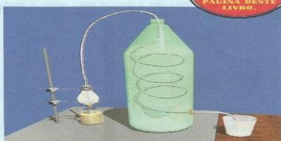
O balão de destilação pode ser substituído por uma jarra de cafeteira elétrica, que resiste ao aquecimento ou uma lâmpada sem filamento, e o condensador por uma mangueira enrolada dentro de uma garrafa descartável de refrigerante do tipo PET. Use sua criatividade para substituir alguns desses materiais, mas tenha sempre muito cuidado.
