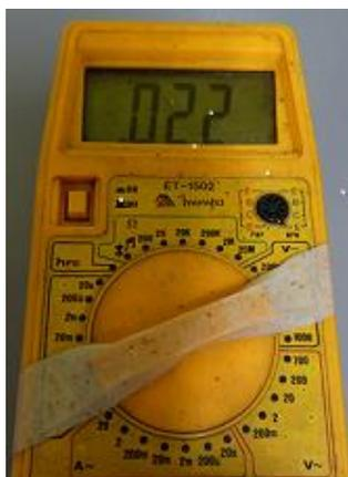
Figura 45. Multímetro empregado para o monitoramento da intensidade de corrente no sistema eletrolítico.
