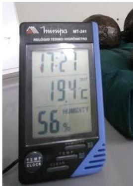
Figura 57. Termohigrômetro empregado no LÂMINA para o controle da temperatura e da umidade relativa do laboratório de conservação.
