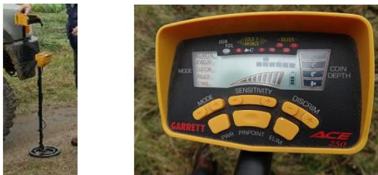
Figuras 6 e 7. Detetores de metal Marca Garrett modelo 250 e detalhe ampliado do visor, onde aparecem os indicadores de profundidade, sensibilidade e tipo de metal.
