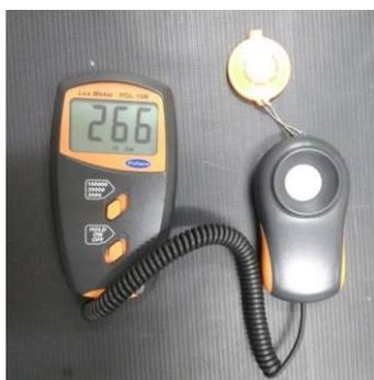
Figura 58. Luxímetro empregado no LÂMINA para a quantificação da intensidade luminosa na área dos trabalhos de conservação.
