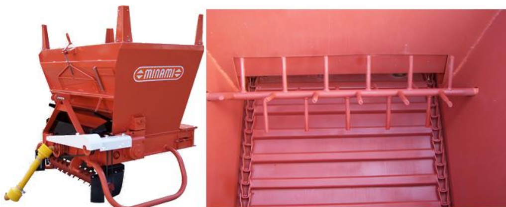
Figura 7. Distribuidora de esterco para canteiro M-90 B. Fonte: Minami, 2013.
