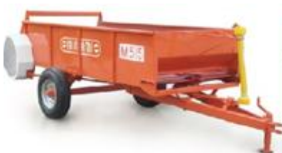
Figura 9. Esparramador de esterco M-515. Fonte: Minami, 2014.
