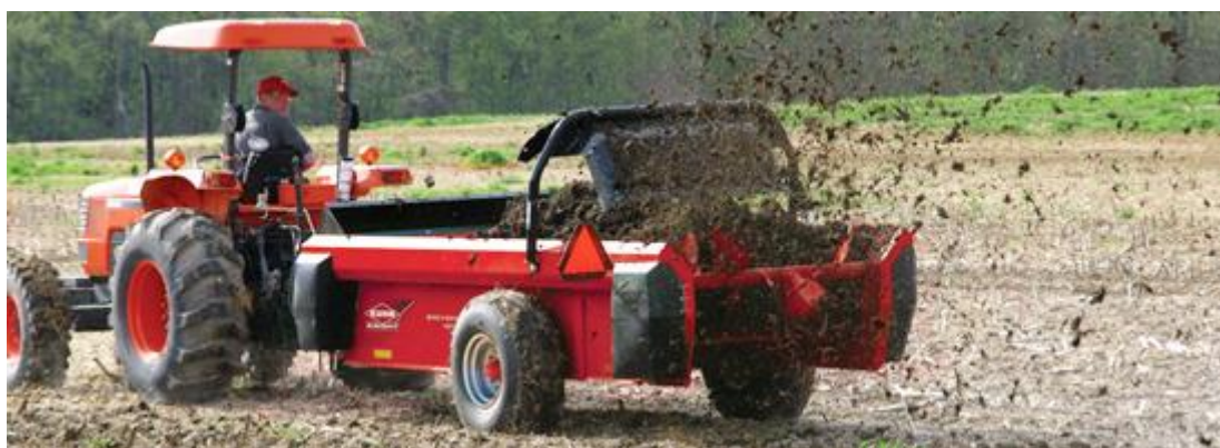
Figura 15. Distribuidor de fertilizante orgânico sólido. Fonte: KUHN, 2015.
