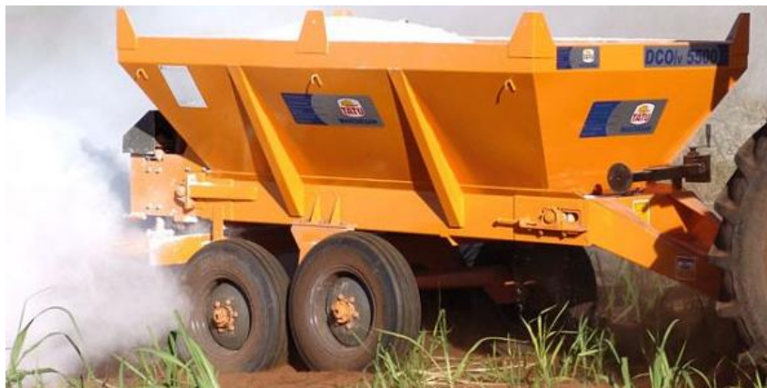
Figura 10. Distribuidor de composto orgânico vibratório DCO/v 5500. Fonte: Marchesan, 2013.
