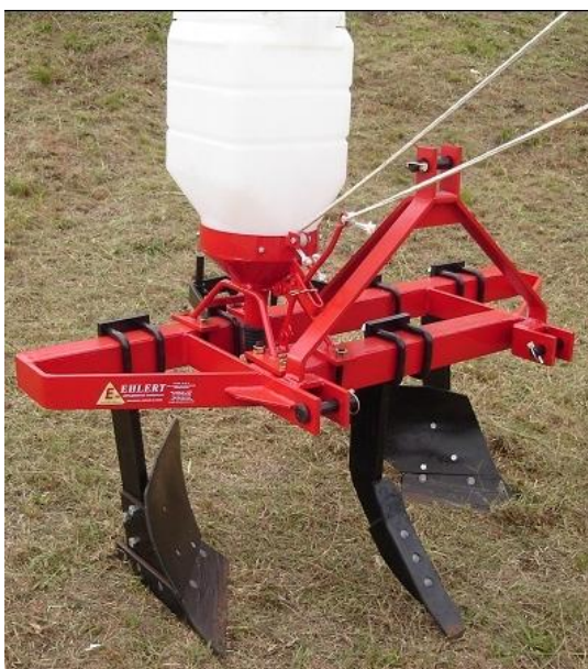
Figura 12. Arado encanteirador com aiveca Ehlert. Fonte: Ehlert, 2015.
