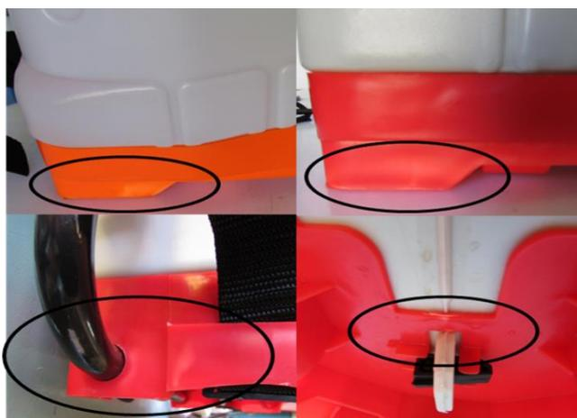
Figura 15 - Deformações provocadas nos equipamentos após ensaio de impacto.
