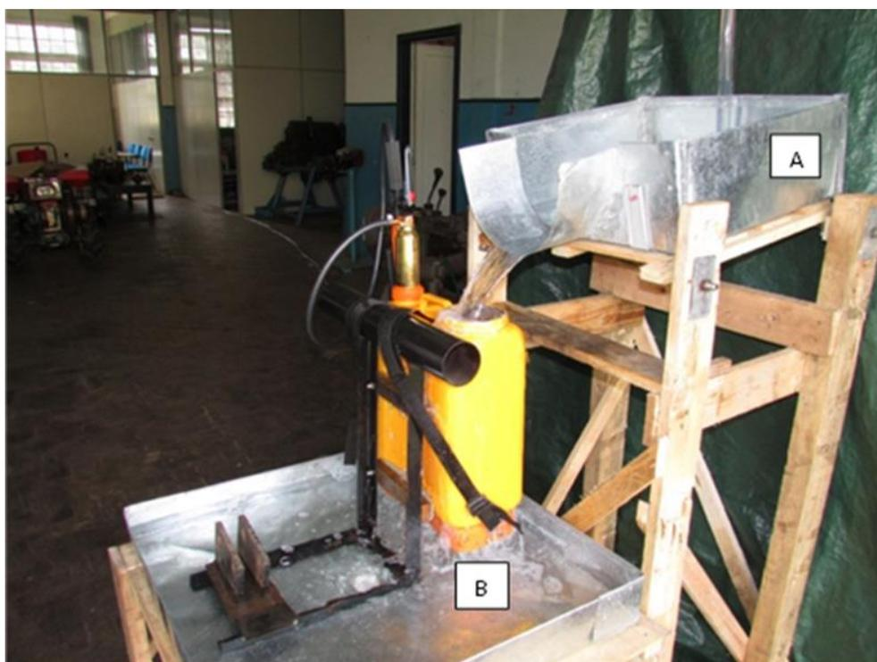
Figura 7 - Dispositivo de ensaio para determinação volume residual externo composto por recipiente de preenchimento (A) e de contenção (B).
