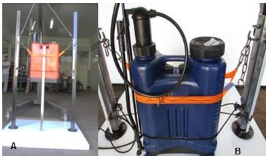
Figura 5 - Dispositivo ensaio impacto onde: (A) vista frontal da realização do impacto, mostrando ao centro a régua de medição da altura e (B) detalhamento da cinta de tração e ancoragem ao sistema de roldanas.
