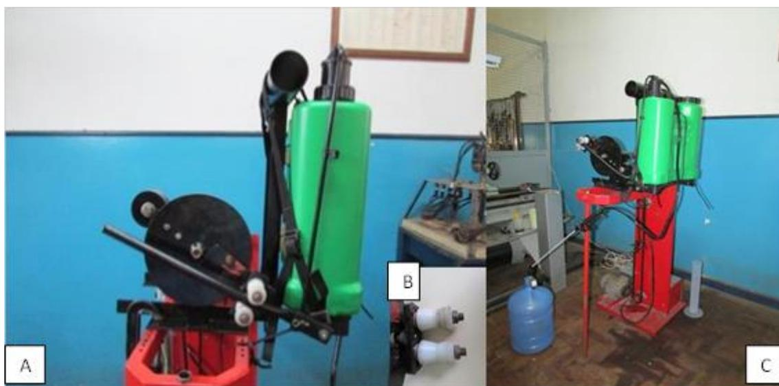
Figura 3 - Bancada para condicionamento dos pulverizadores onde: (A) vista lateral da bancada com mecanismo de acionamento e sistema de acoplamento, (B) detalhe dos roletes em "V" adaptado para diferentes alavancas e (C) vista ampliada da bancada onde pode ser visualizado o recipiente coletor.
