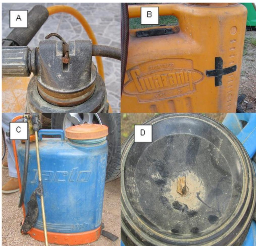
Figura 36 - Reparos realizados pelos agricultores onde: (A) foi utilizado prego para substituir pino de travamento, em (B) obstrução de furo no tanque com fita, (C) tira borracha para estancar vazamento na lança e (D) tarugo de madeira substituindo válvula de alívio.
