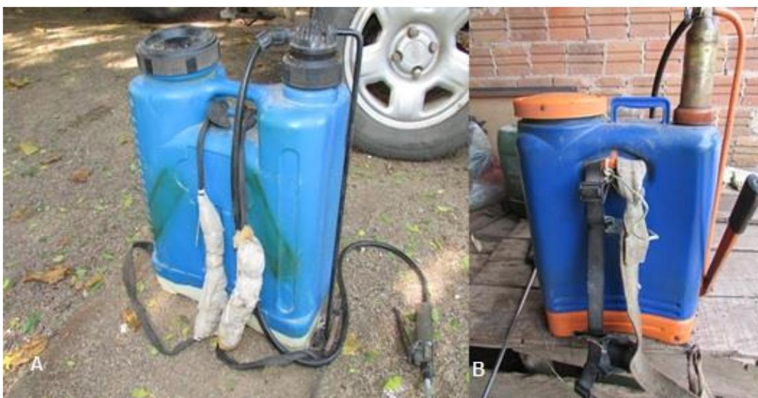
Figura 37 - Adaptações utilizadas para minimizar dores causadas pela correia (A) e a substituição da correia danificada por material alternativo (B).
