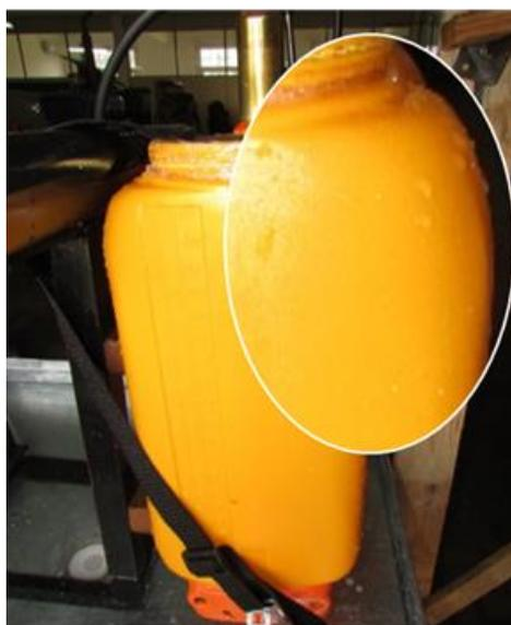
Figura 21 - Formação de gotas na superfície externa.
