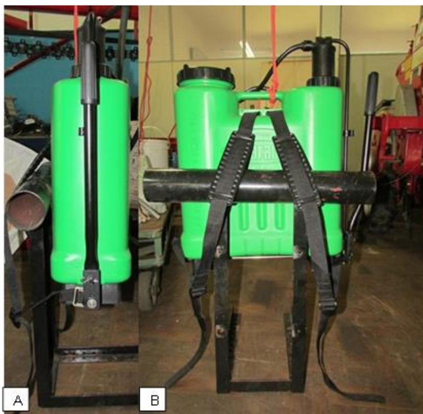
Figura 4 - Dispositivo de ensaio de correia vista lateral (A) e frontal (B).
