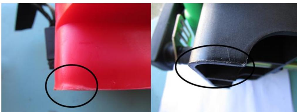
Figura 16 - Deformações ocorridas na base dos pulverizadores durante o ensaio de impacto.
