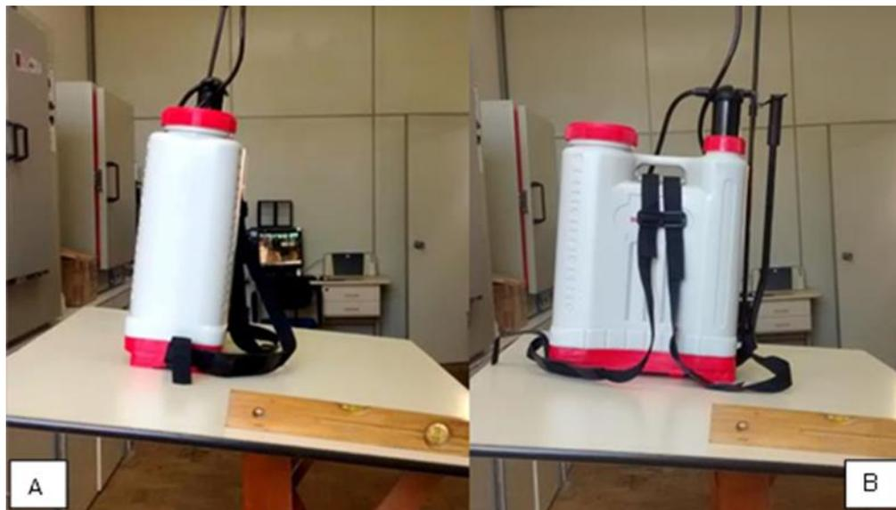
Figura 8 - Ensaio de estabilidade onde (A) vista do posicionamento em 90° paralelo a inclinação e (B) 180° do pulverizador.
