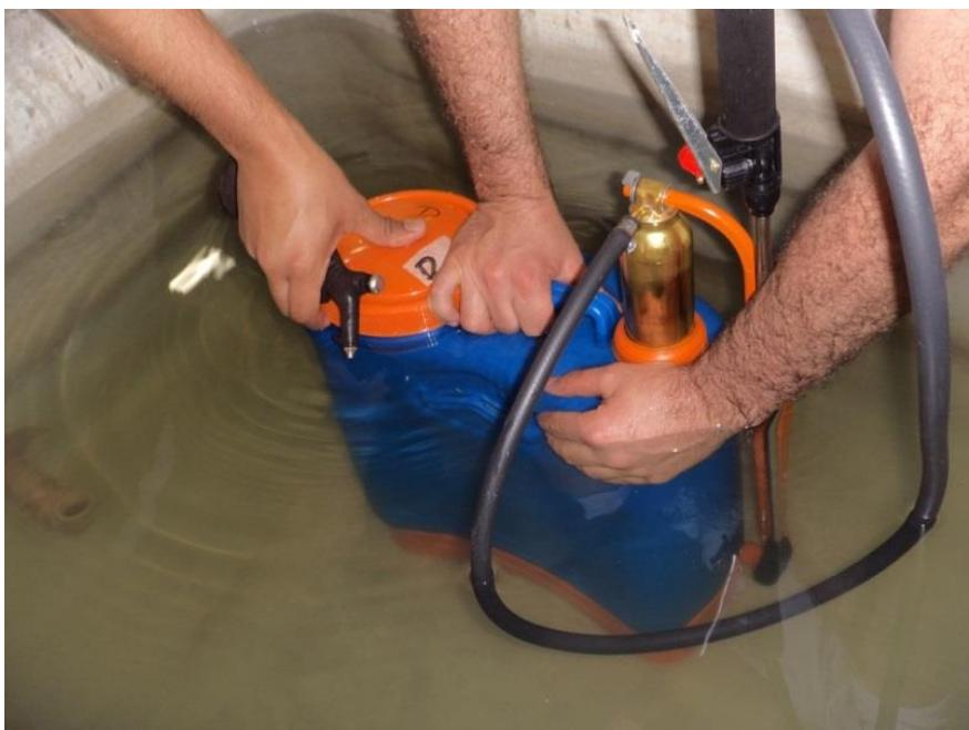
Figura 6 - Ensaio de vazamento realizado em um reservatório de água para a determinação de vazamentos e visualização de possíveis fissuras.
