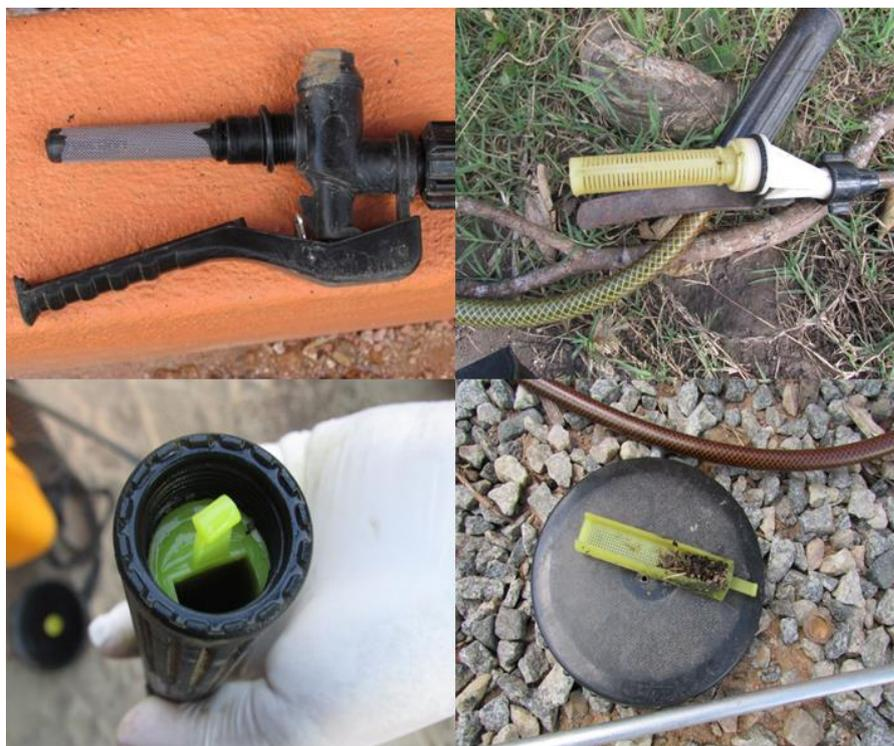
Figura 38 - Filtros contidos na empunhadura do gatilho de acionamento e a presença de resíduos.
