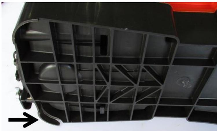
Figura 14 - Rompimento da base do pulverizador F durante ensaio de impacto.
