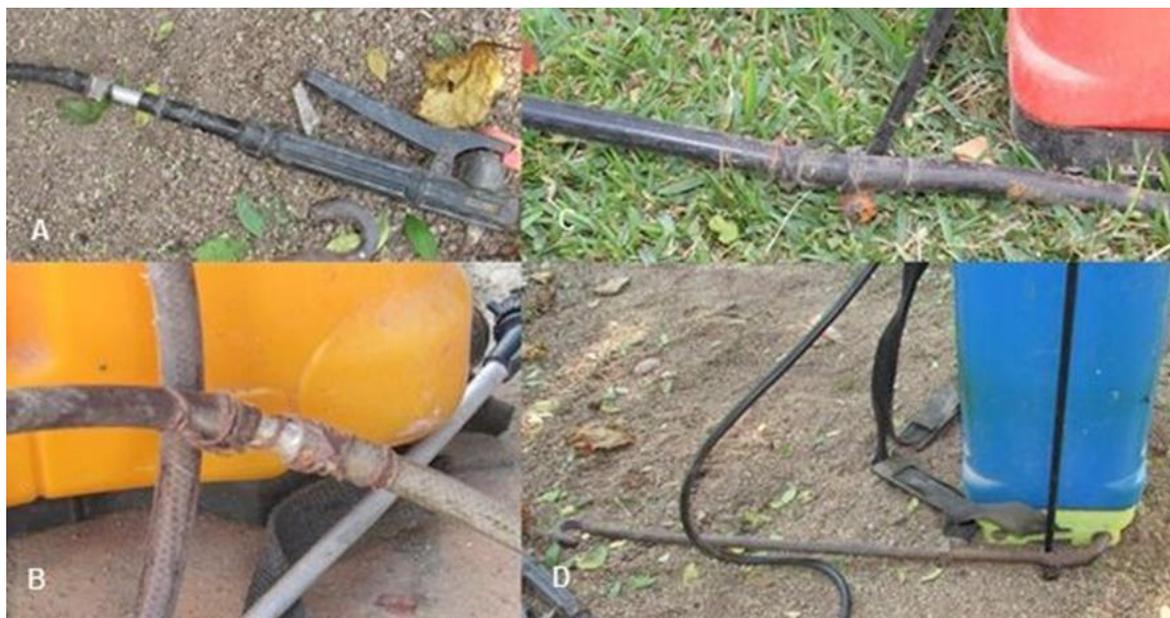
Figura 35 - Reparos para mangueiras e alavancas de acionamento onde: (A e B) apresentam concertos improvisados nas mangueiras e (C e D) nas alavancas sem a devida substituição dos componentes avariados.
