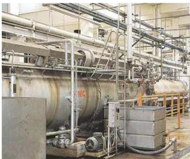
Figura 8- Tratamento térmico Pasteurizados contínuo rotativo.
