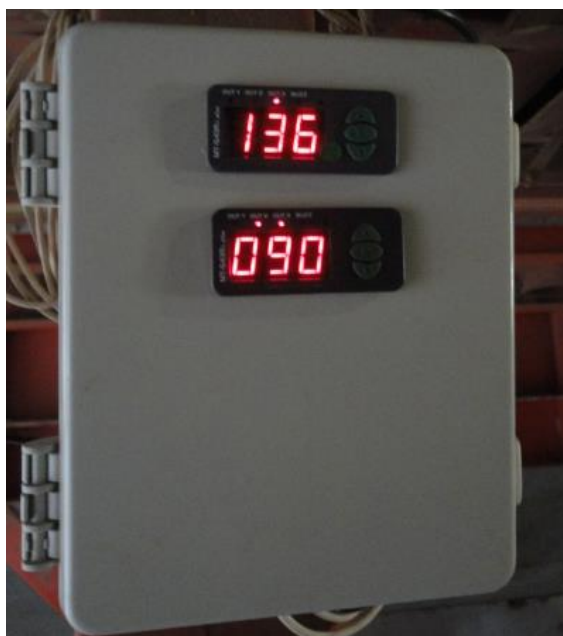
Figura 37 – Registro da temperatura do ar de entrada na câmara quente. Fonte: Acervo do autor (2013)
