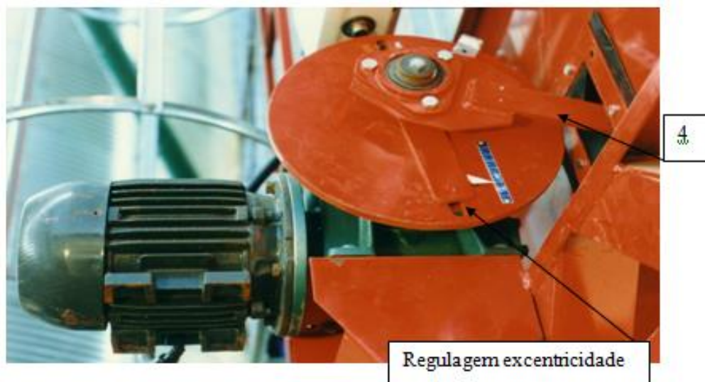
Figura 26 – Regulagem da mesa de descarga do secador. Fonte: Acervo dos autor (2013)
