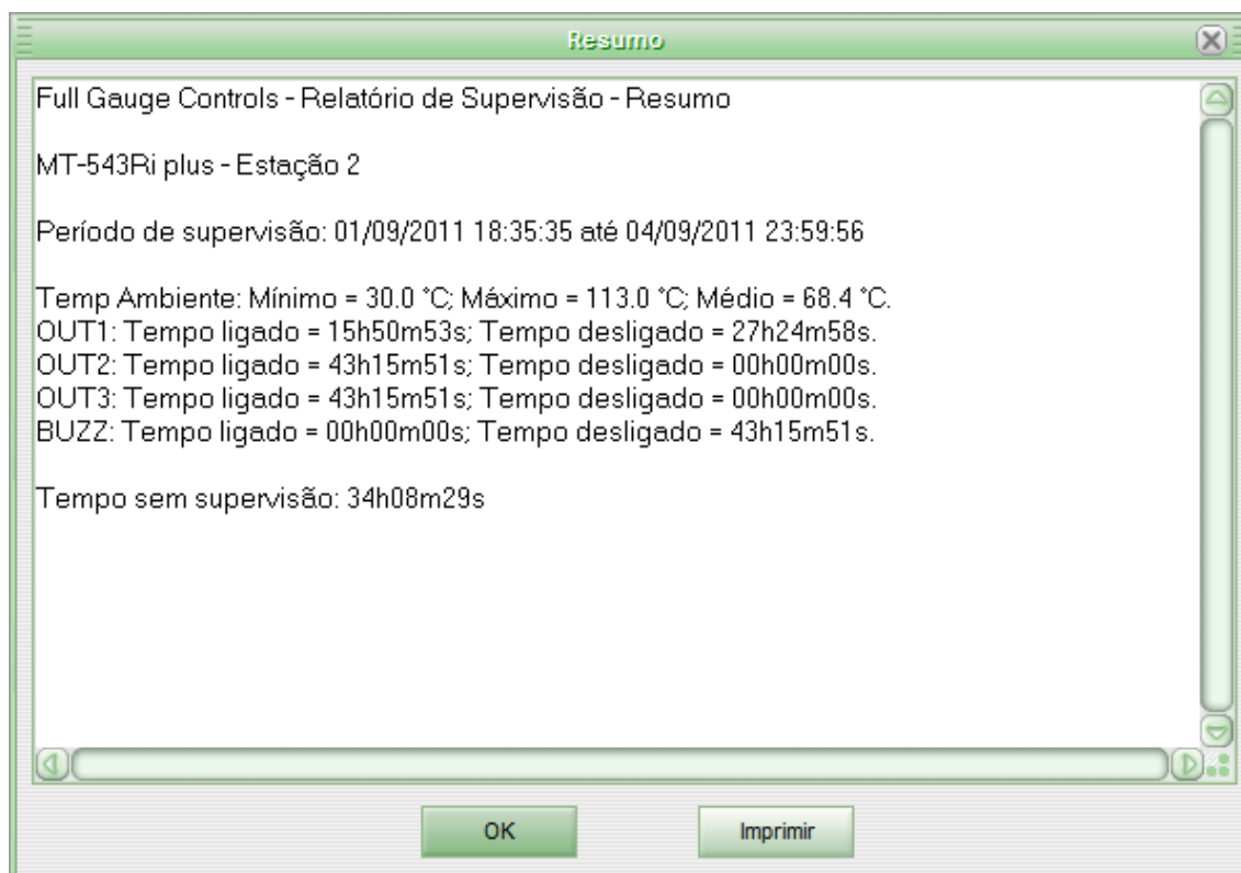
Figura 43 – Resumo das Leituras da temperatura no sistema Sitrad, no software, estação 2, entrada do ar em contato com a massa de grão.
