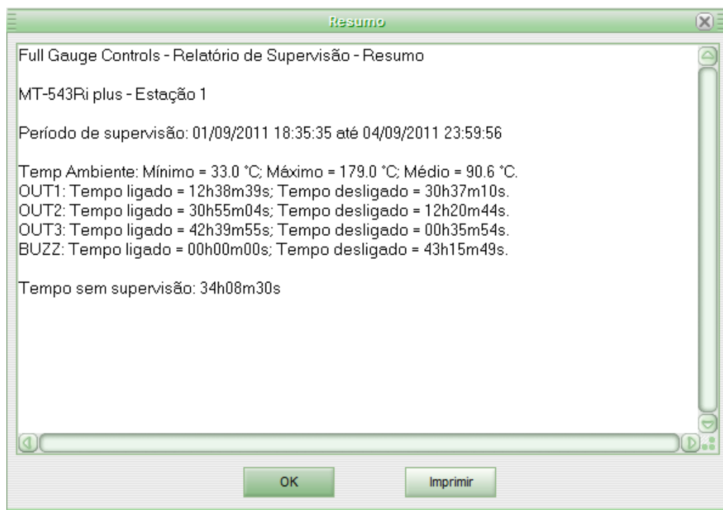
Figura 41 – Resumo das Leituras da temperatura no sistema Sitrad, no software, estação 1, entrada de ar na câmara quente.
