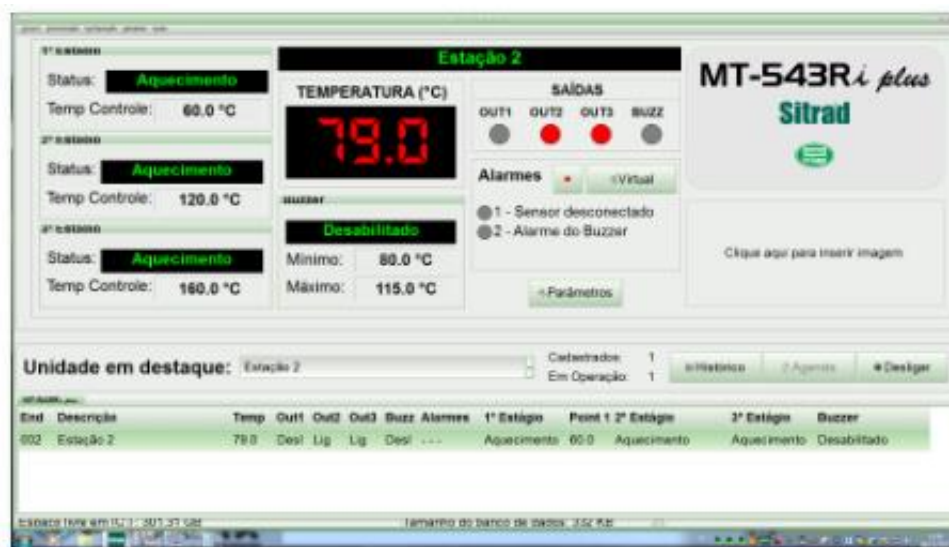
Figura 39 – Leitura da temperatura no sistema Sitrad, no software. Fonte: Acervo do autor (2013)
