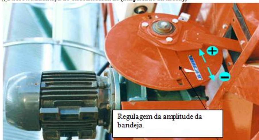
Figura 30 – 4º Passo para regulação da mesa de descarga do secador. Fonte: Acervo do autor (2013)
