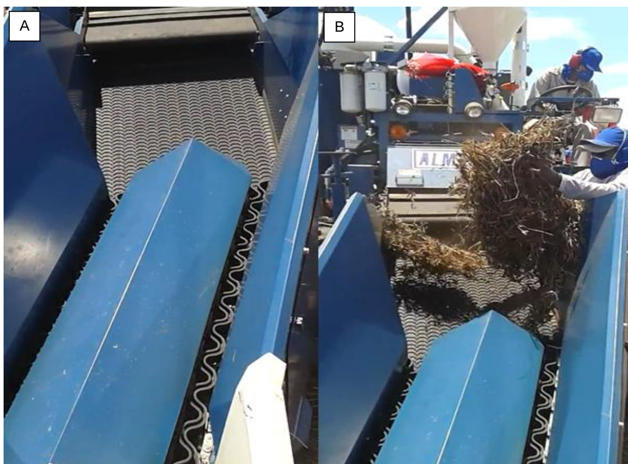
Figura 4. Debulha mecanizada. A – detalhe da trilhadeira; B – materiais sendo debulhados.
