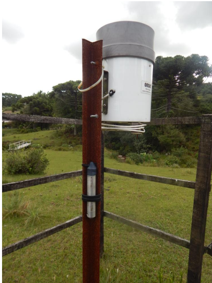
Figura 9 – Sensor de pressão instalado junto à estação pluviométrica, modelo RG 3 -M, marca Onset, localizada próxima à seção de controle da BHSE, no município de Canguçu, Rio Grande do Sul, visando ao monitoramento da pressão atmosférica local
