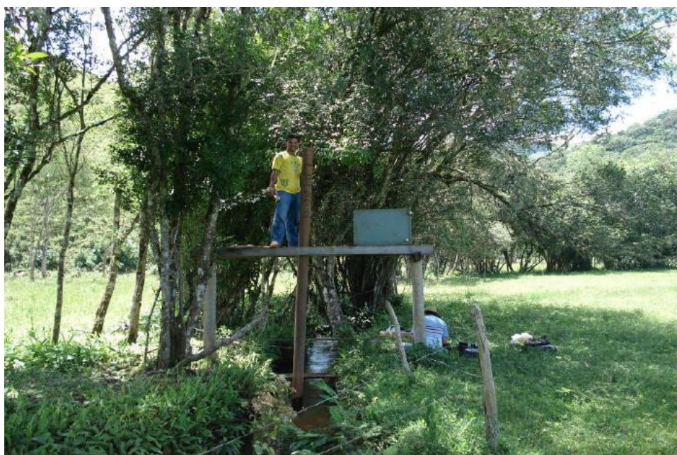
Figura 14- Ilustração da seção de controle da BHRL, com a estrutura para monitoramento automático de nível d'água e da unidade de aquisição e armazenamento de informações hidrológicas da mesma seção
