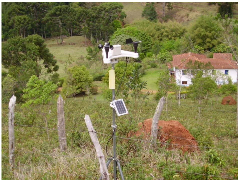
Figura 13- Estação meteorológica instalada no interior da BHRL, no município de Bocaina de Minas, Minas Gerais
