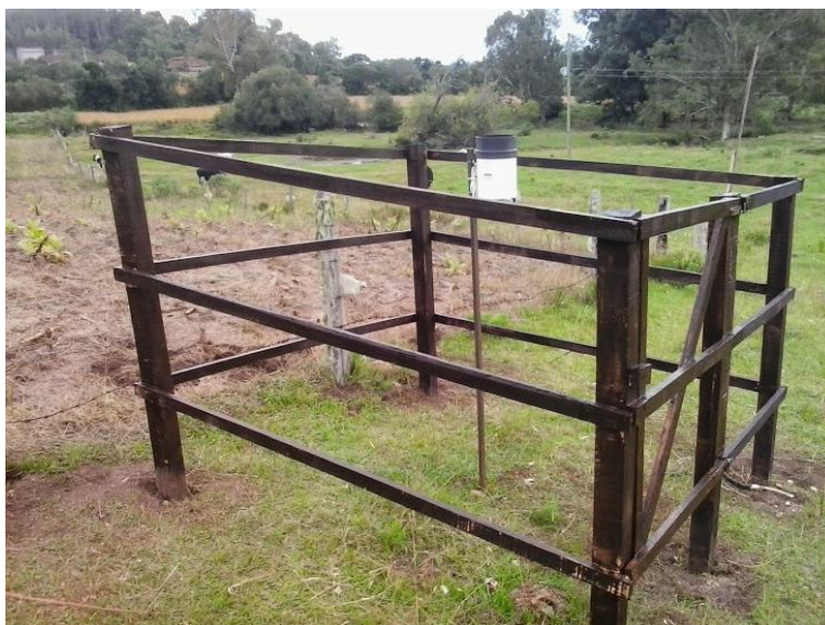
Figura 7- Estação pluviométrica, modelo RG 3 -M, marca Onset, localizada próxima à seção de controle da BHSE, no município de Canguçu, Rio Grande do Sul
