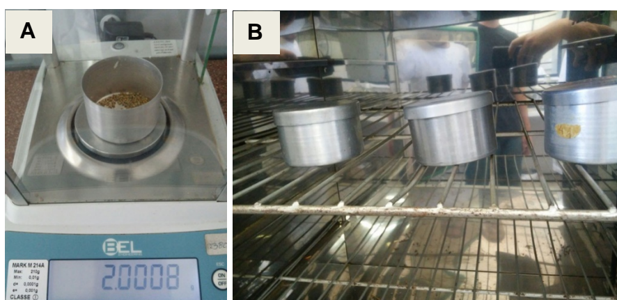
Figura 4 - Montagem do teste de determinação do teor de água, com 2g de sementes de milho em cada repetição, sendo levadas a estufa a 105^{\circ}\text{C} por um período de 24 horas. Utilizando balança analítica de precisão. Pelotas, 2016. *A = pesagem das sementes e B = retirada das sementes de dentro da estufa.
