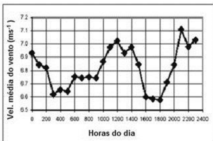
Figura 2.8 – Variação da velocidade do vento durante o dia. Fonte: Adaptado de CLARKE, 2003.
