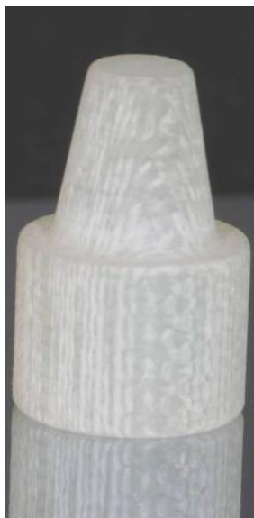
Figura 2 – Modelo em resina epóxica reforçada por fibra de vidro (NEMA granulação G10).
