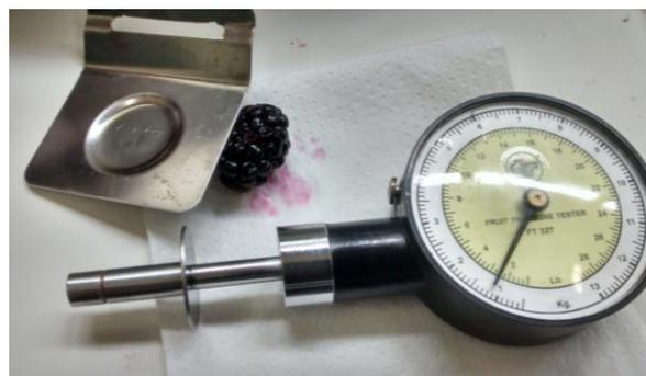
**Figura 15:** Penetrômetro utilizado para avaliar firmeza de frutas de amoreira-preta. Embrapa Clima Temperado, Pelotas/RS, 2017.
