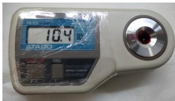
**Figura 16:** Refratômetro utilizado para avaliar SS de frutas de amoreira-preta. Embrapa Clima Temperado, Pelotas/RS, 2017.
