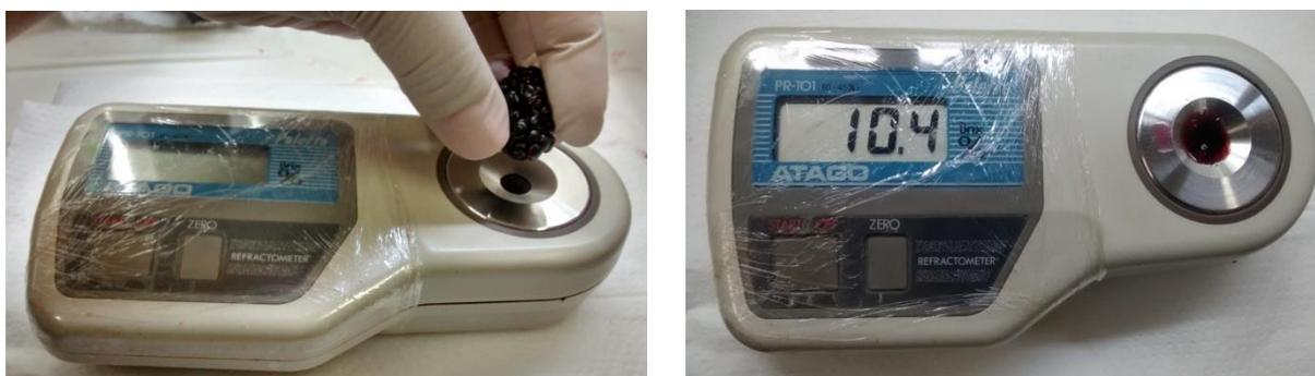
**Figura 1:** Refratômetro utilizado para avaliar SS em frutas de amoreira-preta nas safras 2015/2016 e 2016/2017. Embrapa Clima Temperado, Pelotas/RS, 2017.
