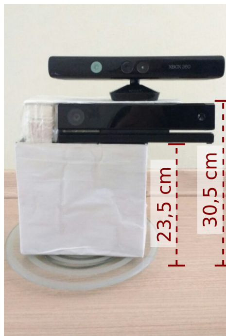
Figura 37 – Posição dos sensores Kinect na captura dos dados.
