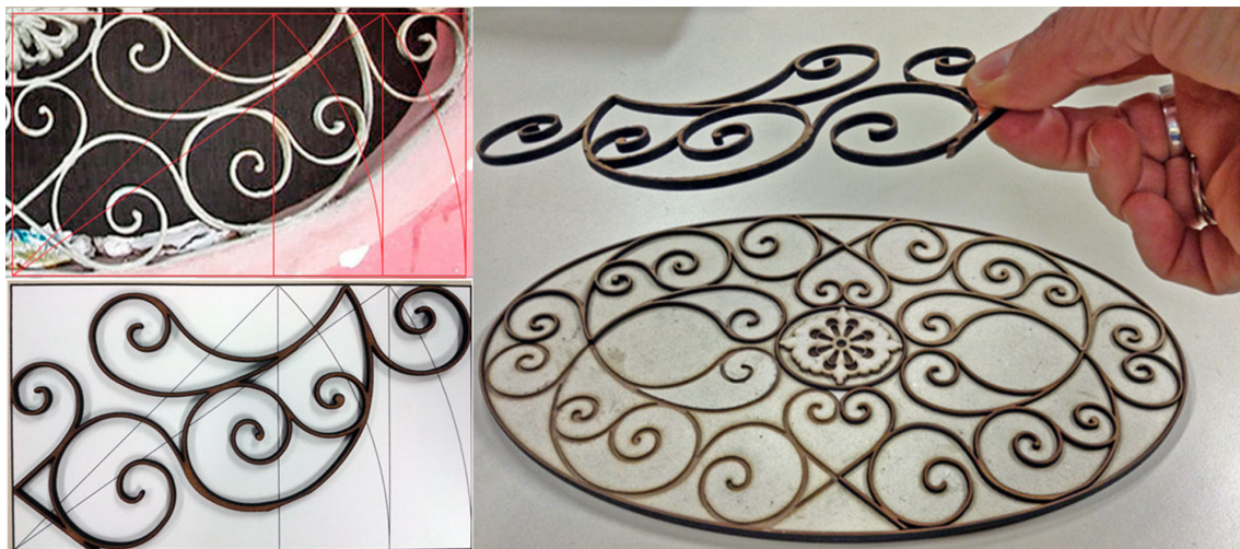
Fig. 5 - Os modelos produzidos por corte a laser para explicar a forma da grade em janela de porão. Fonte: autoras, 2014.
