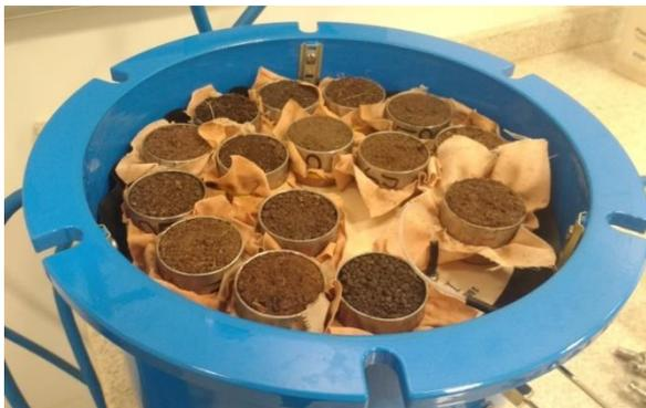
Figura 10 - Câmera de Richards com amostras preparadas para determinação da Curva de Retenção da Água no Solo.
