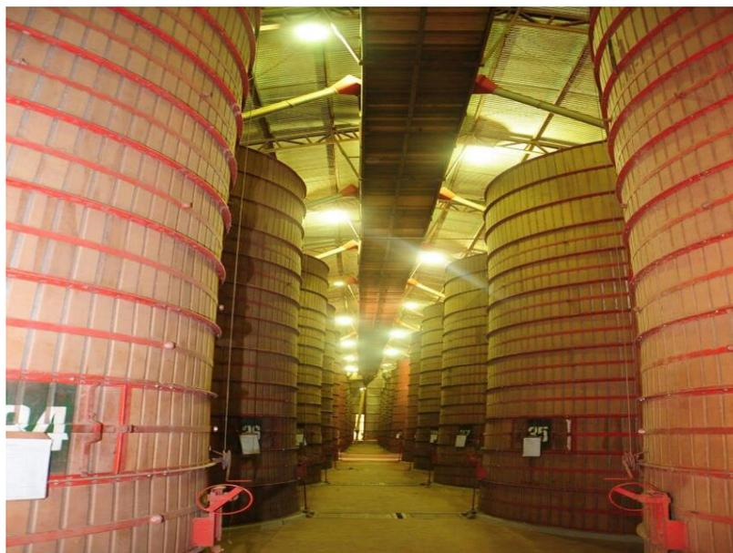
**Figura 10** – Silos de secagem estática e armazenagem
