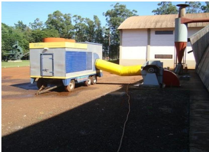
**Figura 12** – Equipamento de resfriamento e secagem
