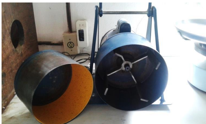
Apêndice C - Escarificador elétrico equipado com lixa 80, 1725 RPM.
