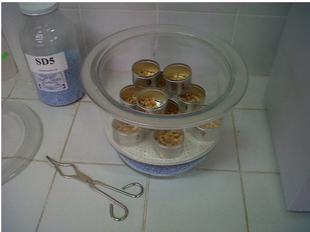
**Figura 6:** Amostras preparadas para prova determinação de umidade
