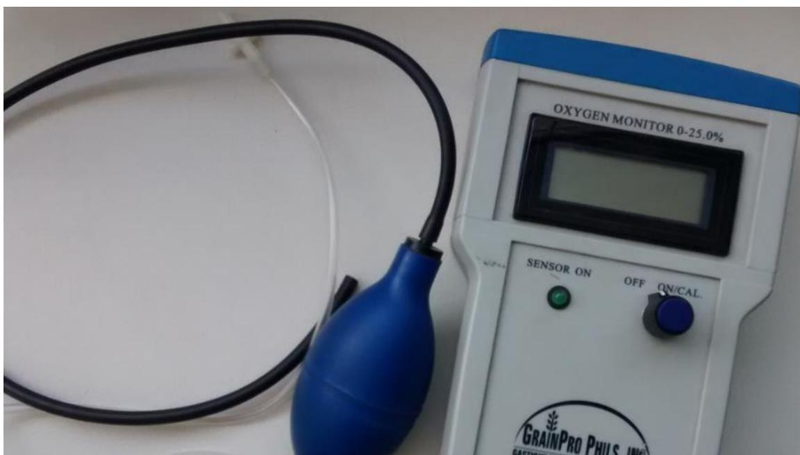
**Figura 5:** Aparelho para medição da concentração de oxigênio.
