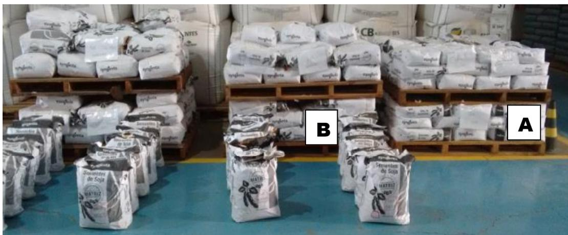
**Figura 1:** Posicionamento de sensores para medição da umidade relativa do ar e temperatura, sendo, **A:** localização no interior da embalagem de papel multifoliado, **B:** localização no interior da embalagem hermética.
