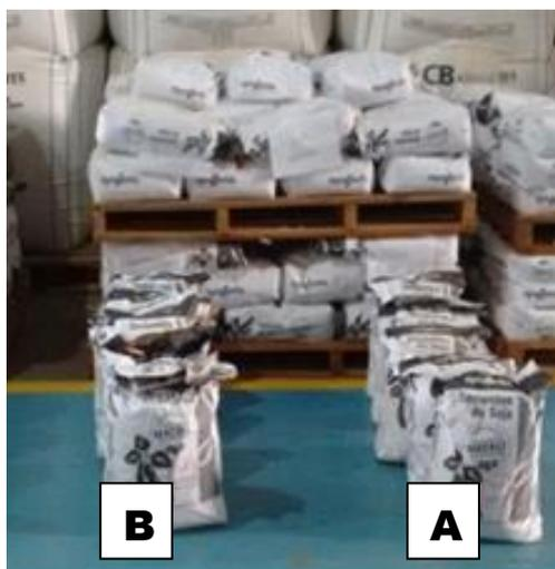
**Figura 4:** Vista das embalagens herméticas para medição da concentração de oxigênio, sendo, **A:** sacaria hermética, **B:** sacaria hermética com injeção de CO<sub>2</sub>.
