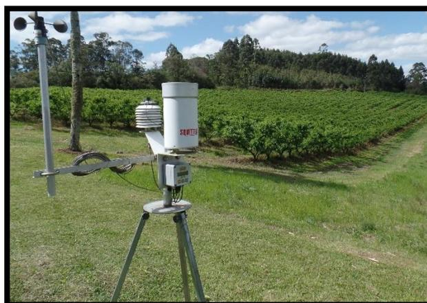
Figura 3 - Estação Agrometeorológica Automática Squitter modelo ISIS S1220, utilizada para monitoramento das variáveis meteorológicas precipitação, temperatura do ar, umidade relativa do ar, radiação solar e velocidade do vento. Fonte: O Autor.
