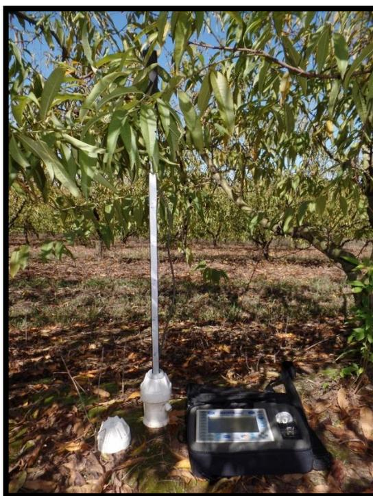
Figura 4 - Sonda de capacitância modelo Diviner 2000® para monitorar o conteúdo de água do solo nas linhas de plantas e respectivo tubo de acesso. Fonte: O Autor.
