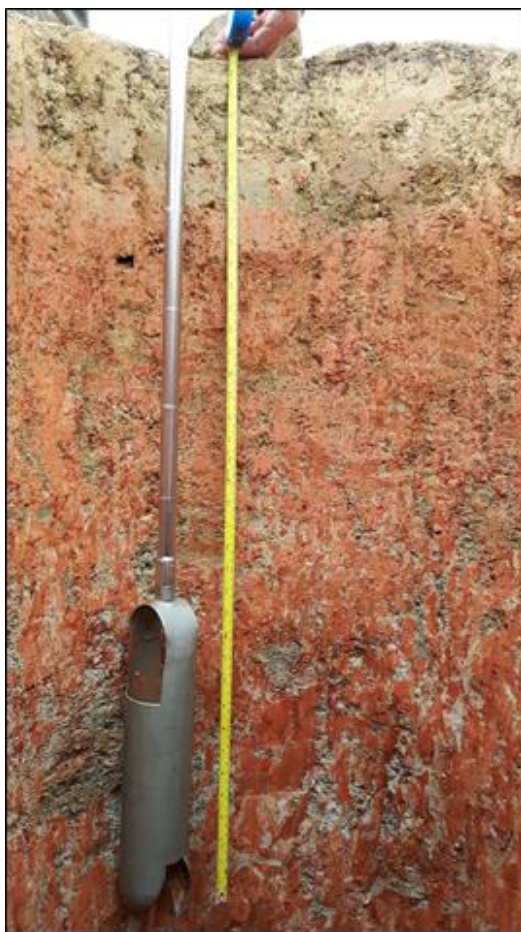
Figura 3 – Aspecto do perfil de solo e do trado tipo caneco usado na perfuração dos poços na profundidade de 100cm.
