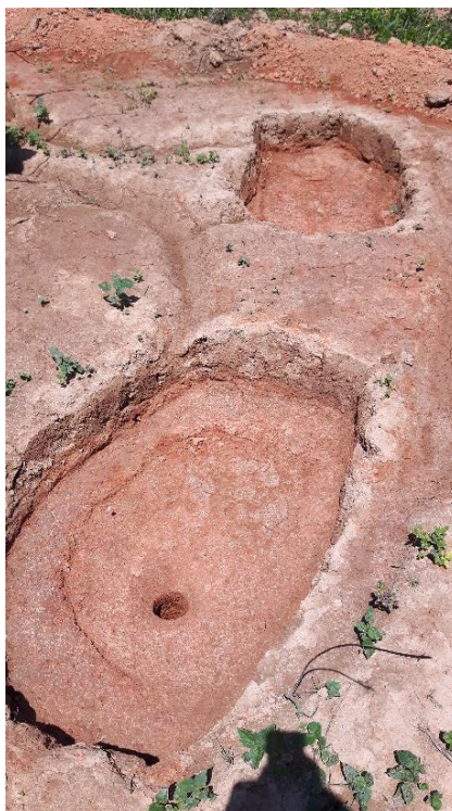
Figura 2 – Aspecto dos poços prontos para o alagamento para permitir a saturação do solo.
