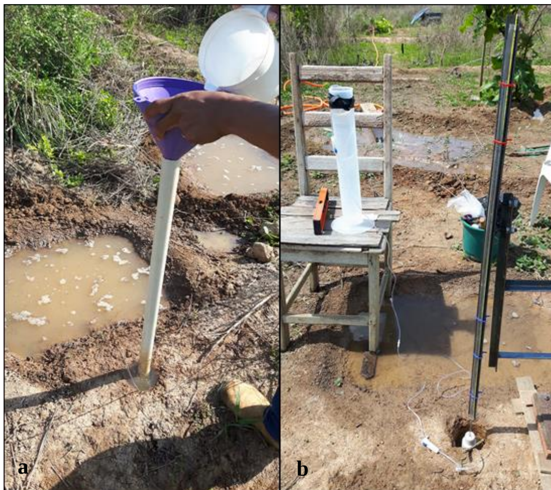
Figura 6 – Dique ao lado da taipa com lâmina de água e a aplicação de água no poço para saturação do solo (a); realização da condutividade hidráulica na taipa após a saturação do solo (b).
