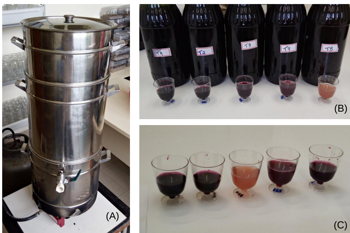
Figura 4. Panela extratora a vapor (A); sucos e cortes de uvas ‘Bordô’ e ‘Niágara Rosada’ (B e C).
