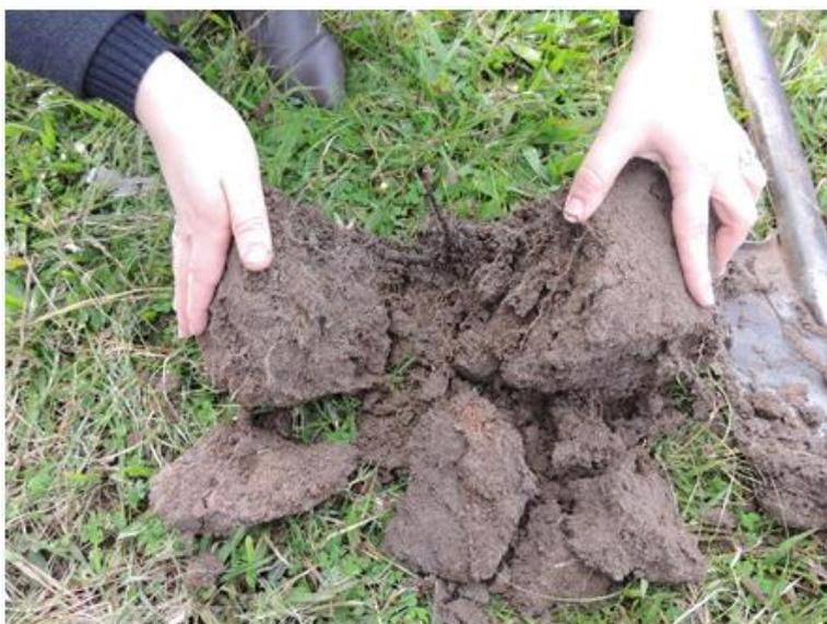
Figura 8 - Bloco de solo sendo quebrado com as mãos para avaliação da agregação do solo.
