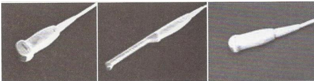
Figura 18 – Tipos de sonda compatíveis com o ultrassom Mindray DP 6600 , da esquerda para a direita: microconvexa (35C20EA), endocavitária (65EC10EA) e microconvexa (65C15EA). Figura reproduzida de Ferreira-Gonçalves e Brum-de-Paula (2013, p. 101)
