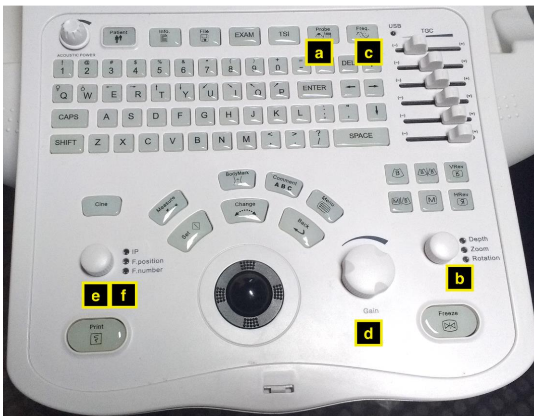
Figura 22 – Imagem do teclado do aparelho Mindray DP 6600 com algumas funções sinalizadas: Probe (a); Depth – profundidade (b); Freq. – frequência (c); Gain – ganho (d); IP (e) e F. position – posição do foco (f)
