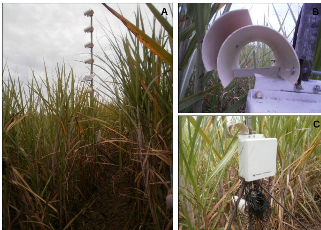
Figura 4. Torre com sensores de temperatura do ar (A), mini abrigo de PVC com sensor de temperatura do ar (B), caixa com sistema automático de armazenamento de dados, datalogger (C), Pelotas/RS, 2016.
