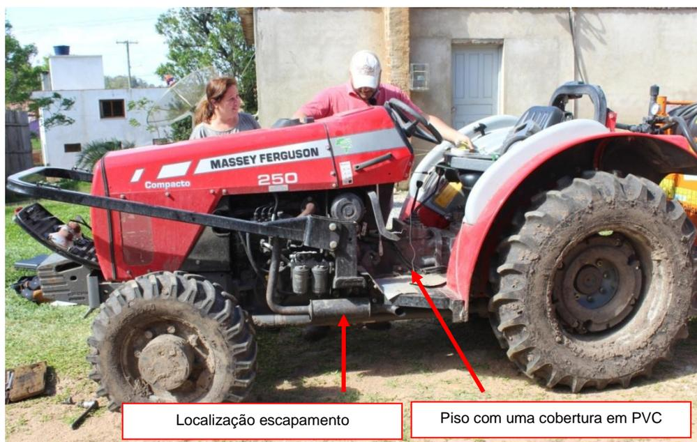
Figura 65 - Detalhe do piso e do escapamento
