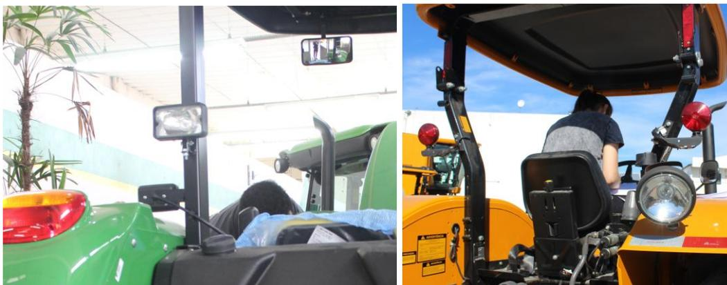
Figura 64 - Registro dos dispositivos de iluminação e sinalização para tráfego
