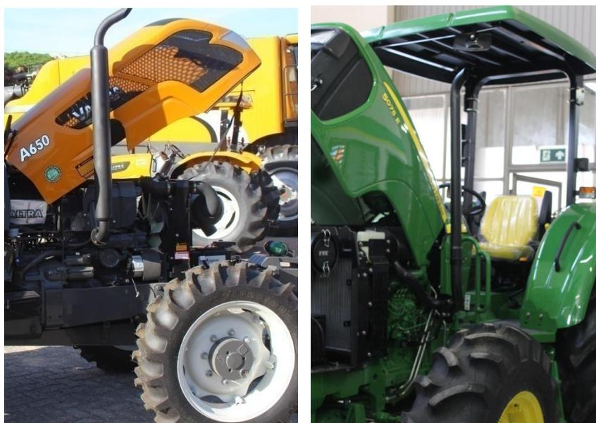
Figura 66 - (a) Localização do escapamento sem acesso ao posto do operador, mas sem grade de proteção e 66 (b) Localização do escapamento sem grade de proteção no acesso de entrada do posto do operador
