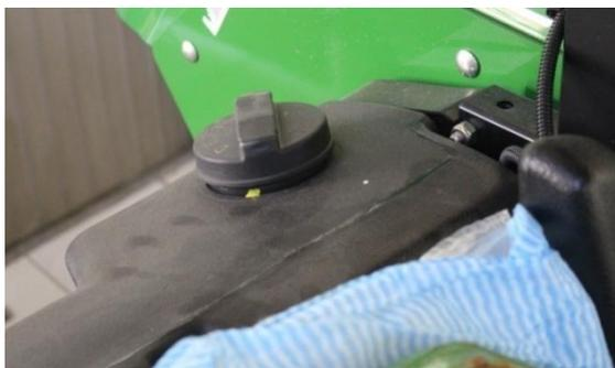
Figura 71 - Localização do tanque de abastecimento atrás do assento do operador.
