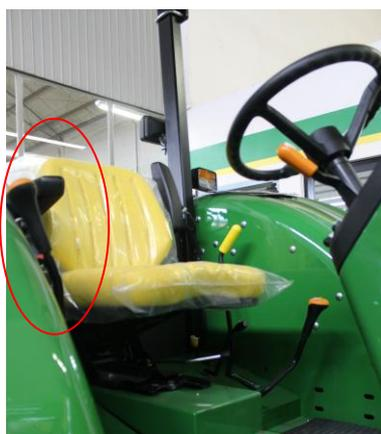
Figura 59 - Alavanca de troca de marchas com a posição de estacionamento em P
