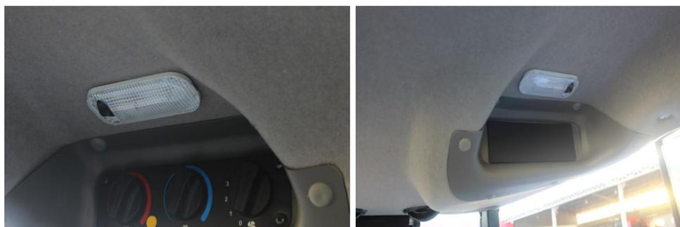
Figura 58 - Iluminação interna no trator avaliado da marca Case Farmall 80
