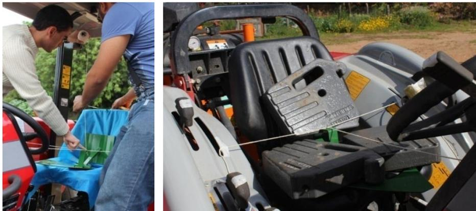
Figura 25 - Dispositivo para a determinação do SIP posicionado sobre o assento de um posto de operação amostrado.
