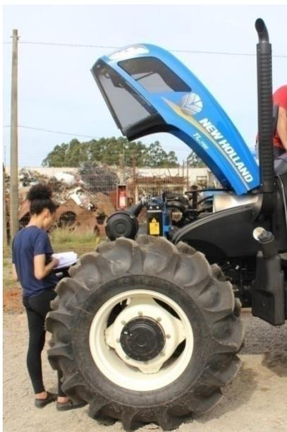
Figura 68 - Escapamento com proteção
