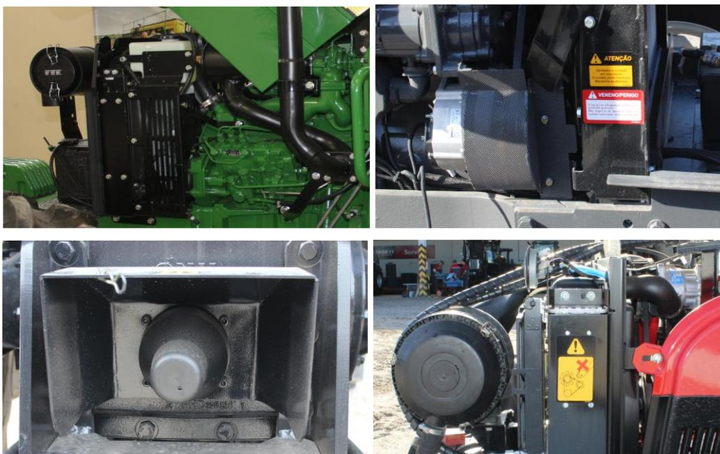
Figura 60 - Dispositivos de proteção
