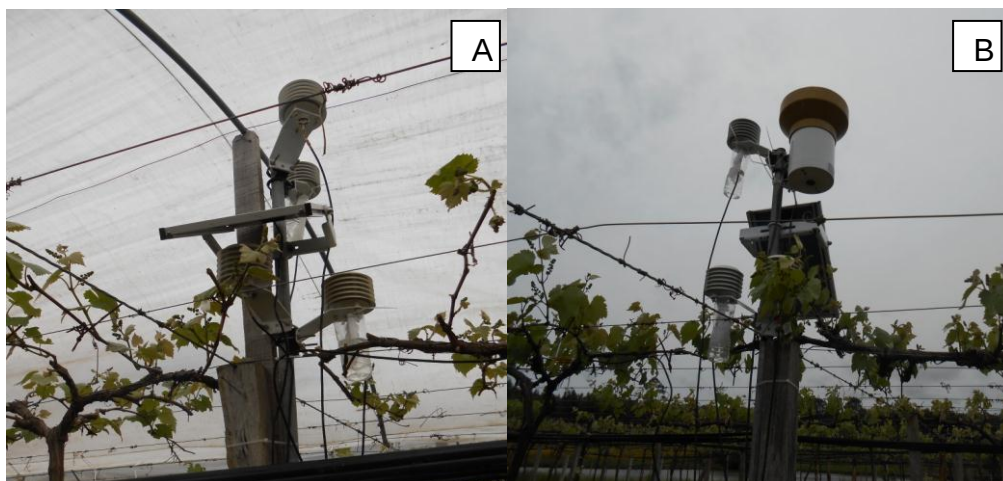
Figura 9: Termômetros em abrigos termométricos nos ambientes de cultivo de videira ‘Niágara Rosada’ com cobertura (A) e sem cobertura (B). Pelotas/RS. Fonte: BORGES, 2014.
