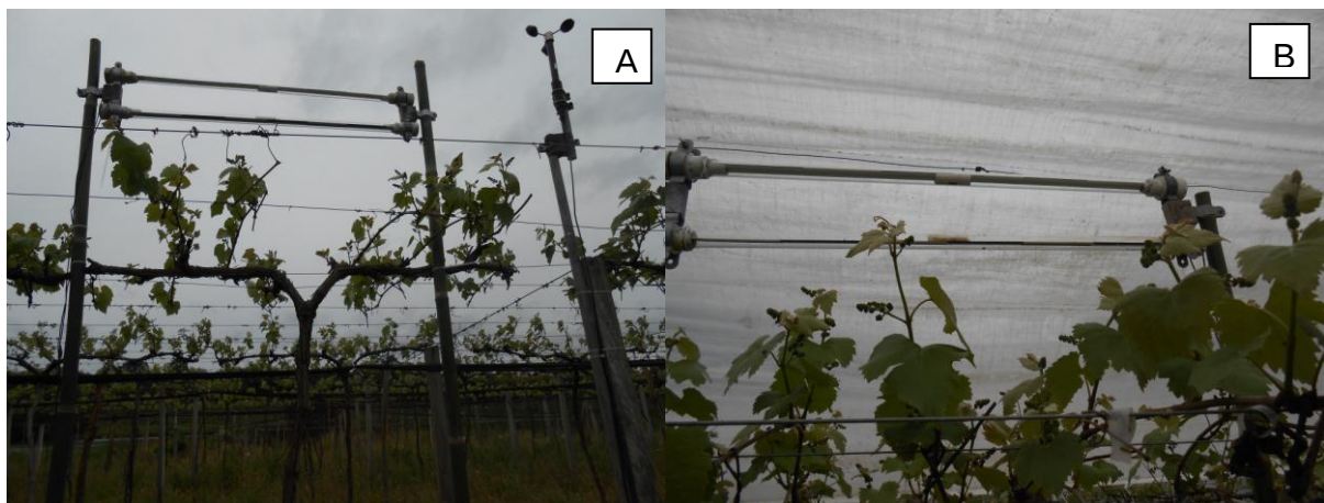
Figura 8: Tubos Solarímetros nos cultivos de videira 'Niágara Rosada' sem cobertura (A) e com cobertura (B). Pelotas/RS. Fonte: BORGES, 2014.
