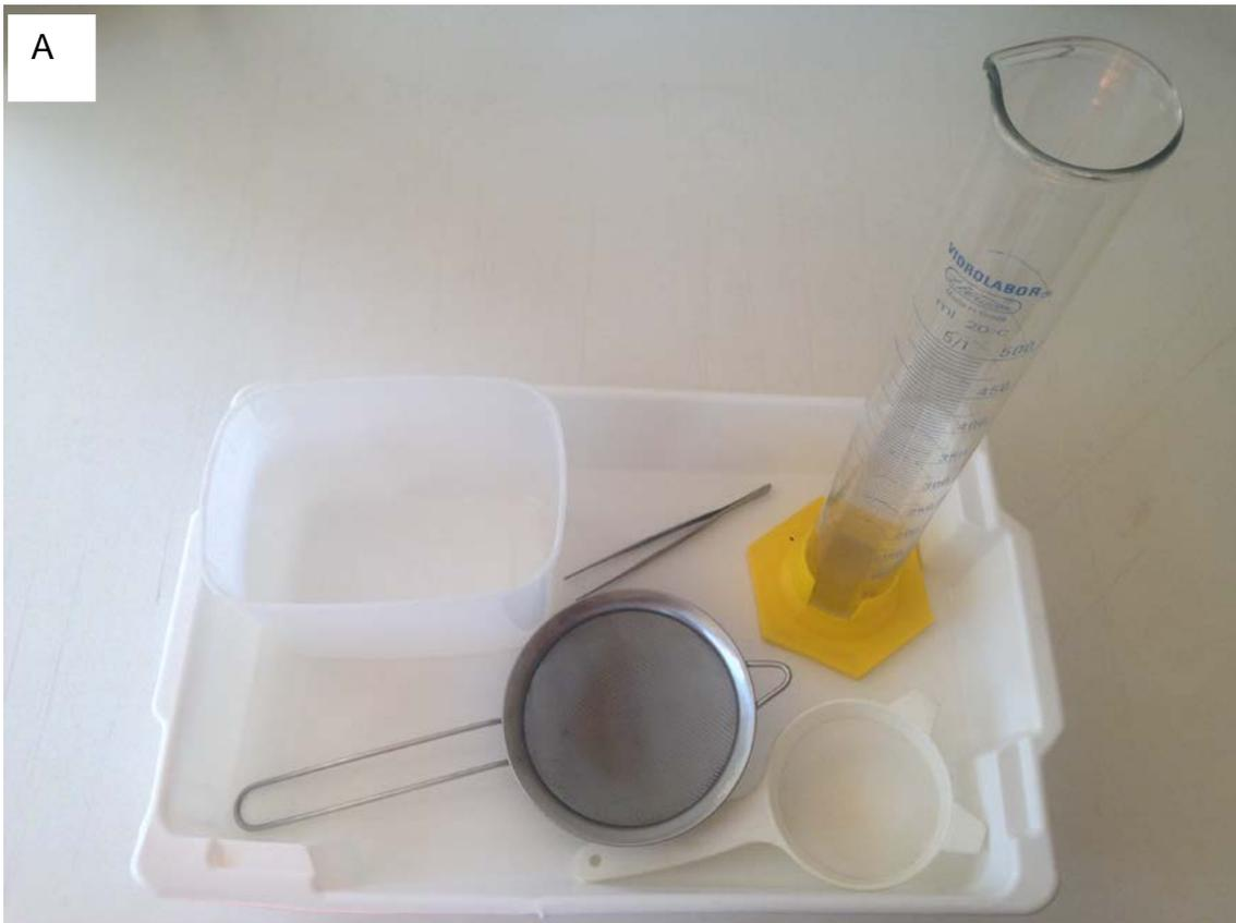
**Figura 6.** Materiais utilizados na obtenção do sistema radicular. A: Proveta, peneiras, pinça e recipiente utilizado para lavagem das raízes
