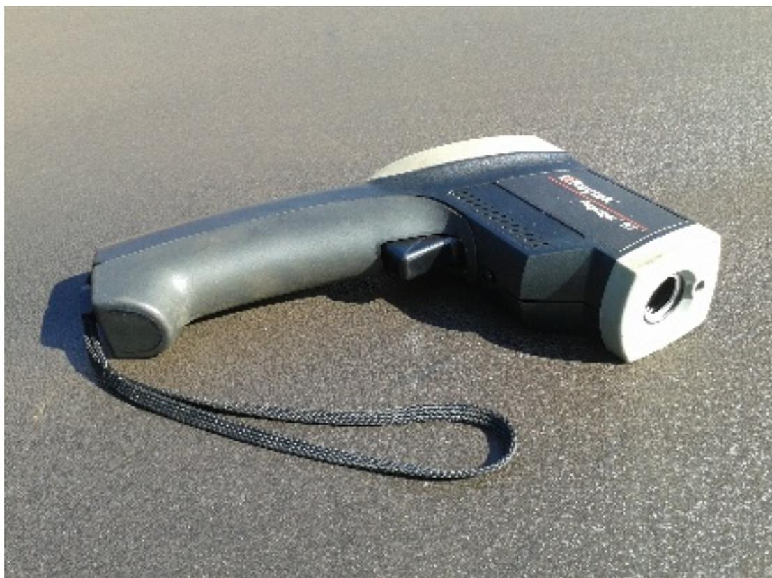
**Figura 4.** Termômetro infravermelho utilizado para determinar a temperatura foliar.
