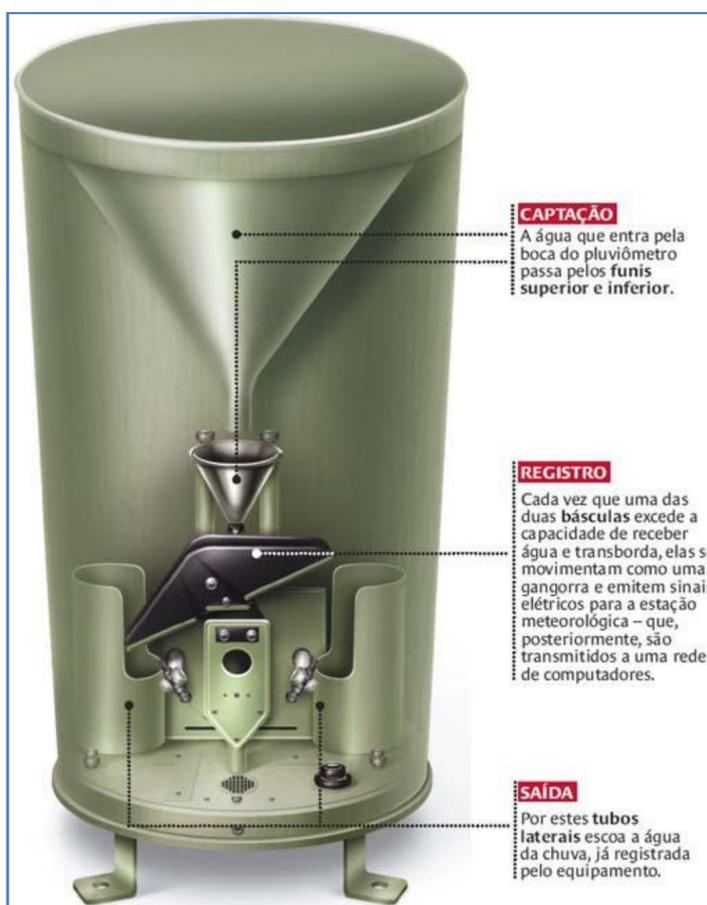
Figura 1 Ilustração de funcionamento de um pluviômetro do tipo de Bâscula.
