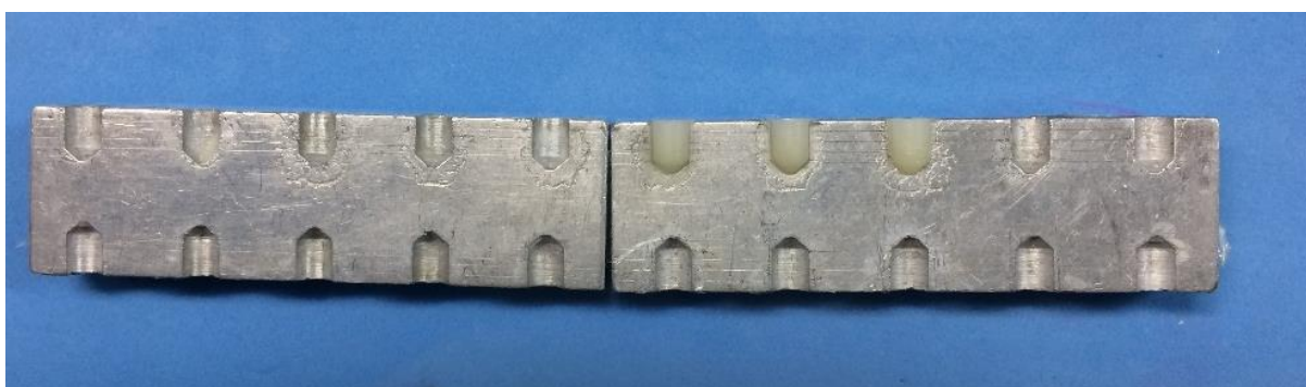
Figura 7. Matriz utilizada para avaliação da profundidade de polimerização. Após a polimerização do material, os espécimes são removidos da matriz e realizado a raspagem do material não-polimerizado.
