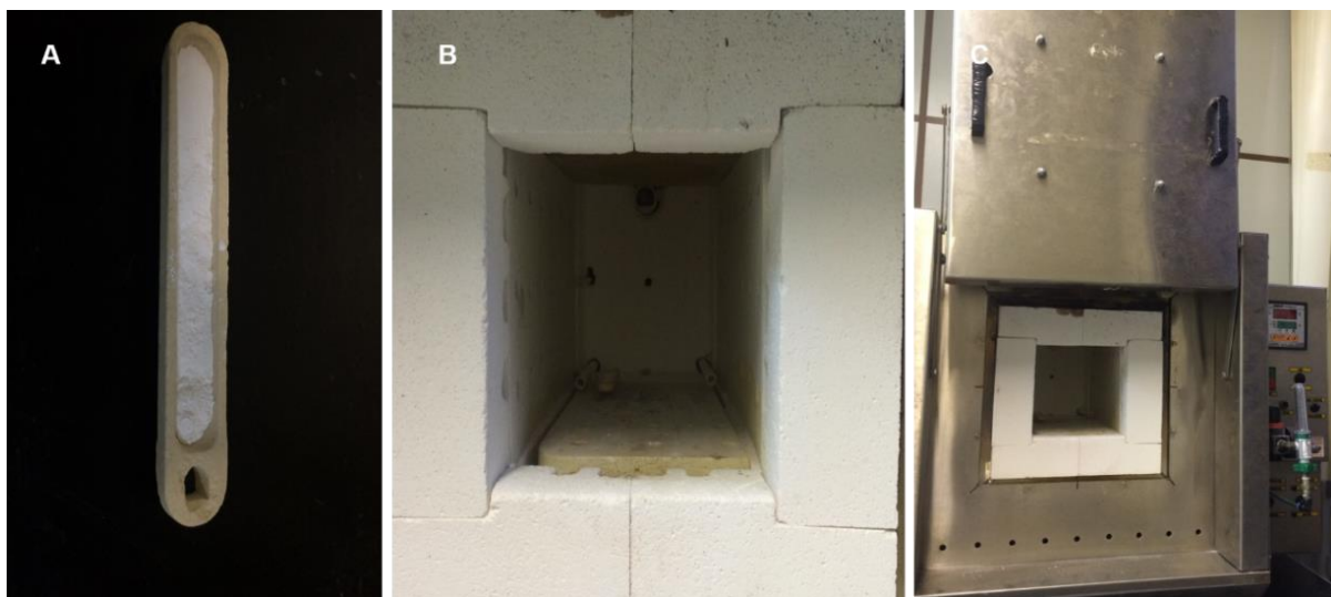
Figura 3. Calcinação das nanopartículas. A) Após a evaporação do solvente, as nanopartículas foram acomodadas em barquinhas. B) As barquinhas eram posicionadas dentro do forno. C) Forno utilizado no processo de calcinação.
