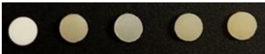
Figura 9. Espécimes avaliados para opacidade. Da esquerda para a direita: ZrSi, AlSi, OX50, Aerosil 150 e Filtek Z350.
