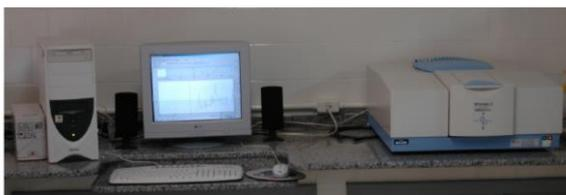
Figura 4. Imagem do aparelho de Espectroscopia FTIR.
