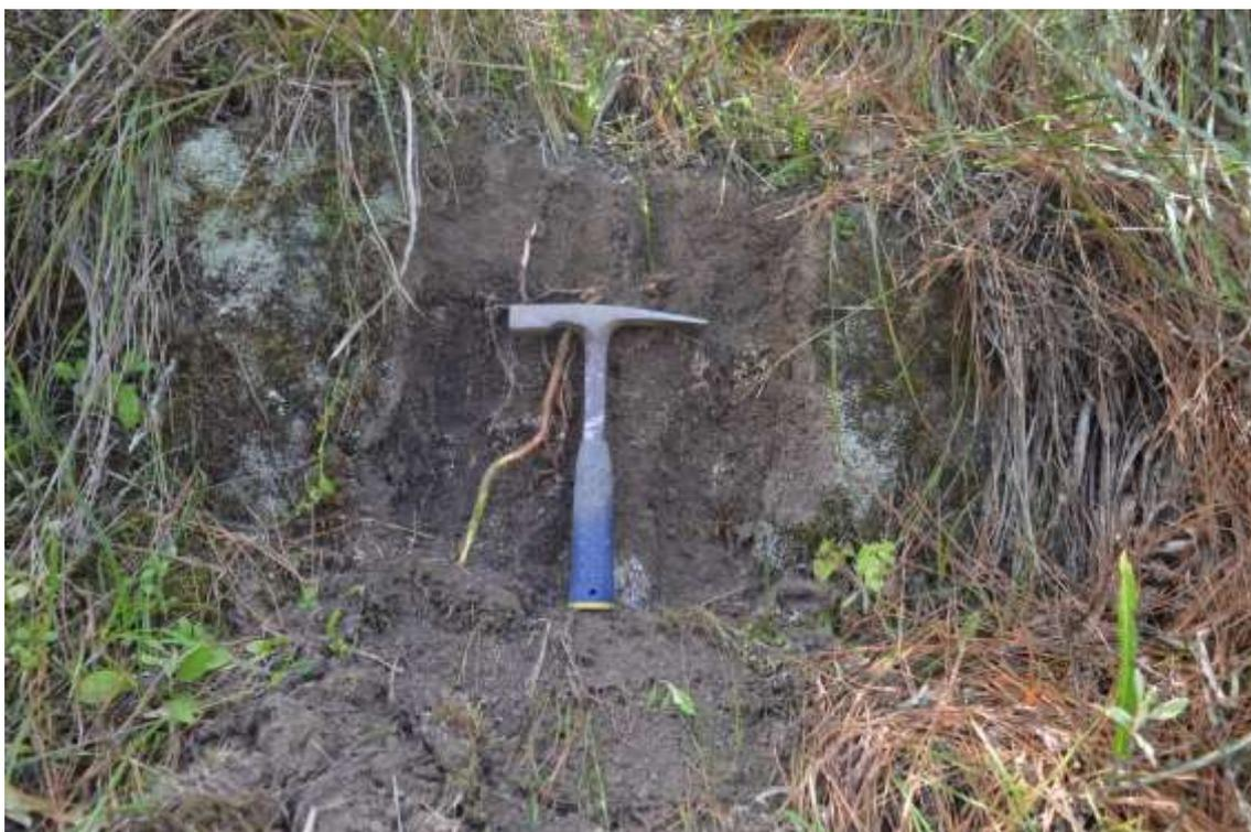
Figura 33: Perfil do solo junto à superfície de ruptura do movimento de massa.
