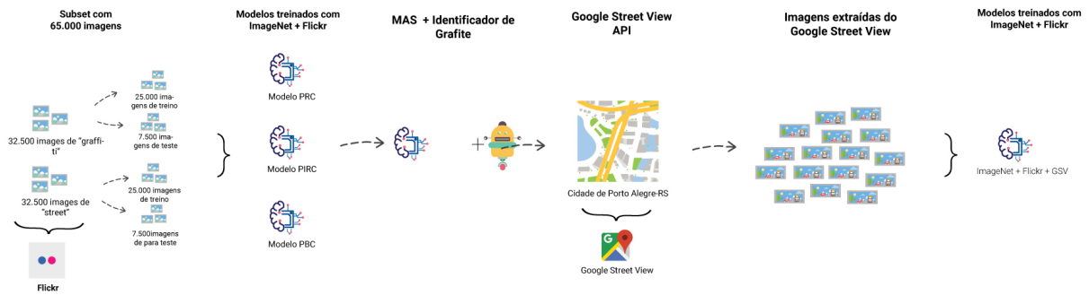
Figura 14 – A imagem demonstra o subset do Flickr utilizado para o fine-tuning em três modelos. O melhor modelo é utilizado para novo fine-tuning com imagens de grafite do GSV.
