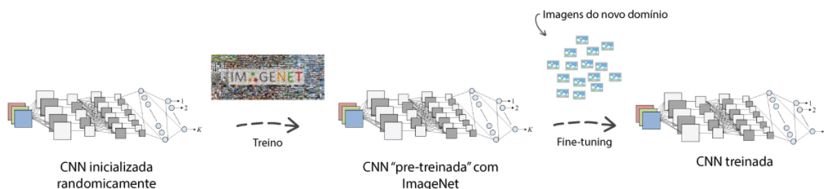
Figura 6 – A imagem demonstra como é realizado o processo de “pré-treinamento” de uma CNN com um dataset chamado de ImageNet e posteriormente o modelo é treinado para um novo domínio.
