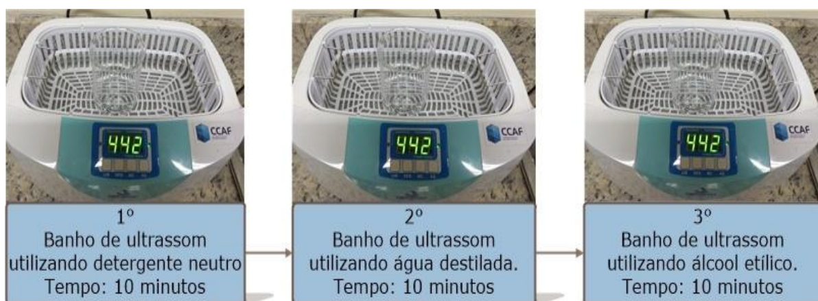
Figura 10 – Limpeza dos substratos de vidro através do banho de ultrassom. Fonte: Próprio autor.
