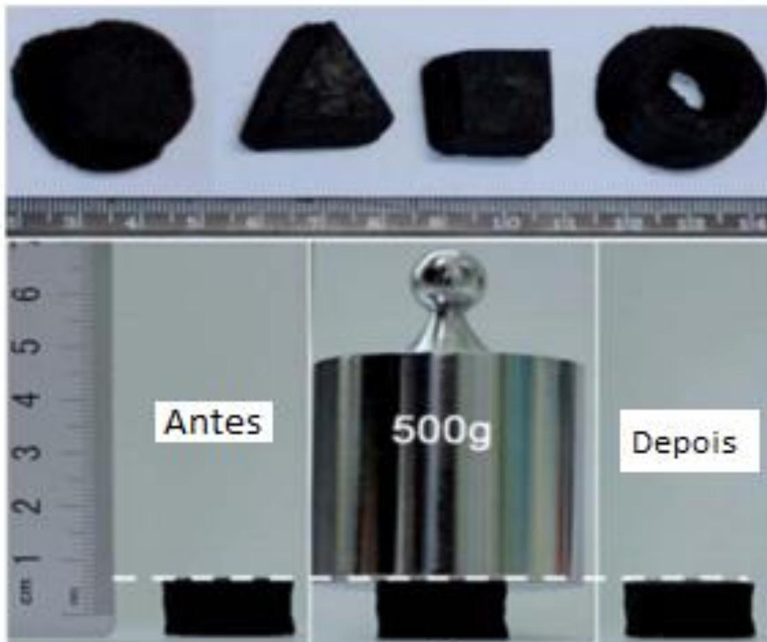
**Figura 8.** Imagens ópticas de Esponjas de OGR cortado com diferentes formas, mostrando sua alta estabilidade estrutural e boa processabilidade e imagens ópticas de um OGR antes do carregamento, carregado e após descarregar um contrapeso, mostrando sua boa propriedade mecânica (ZHAO, REN e CHENG, 2012).
