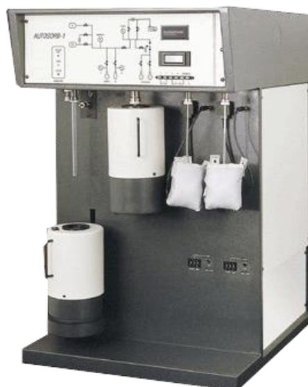
**Figura 12.** Equipamento utilizado para as análises da área superficial e distribuição de Tamanhos de Poros.
