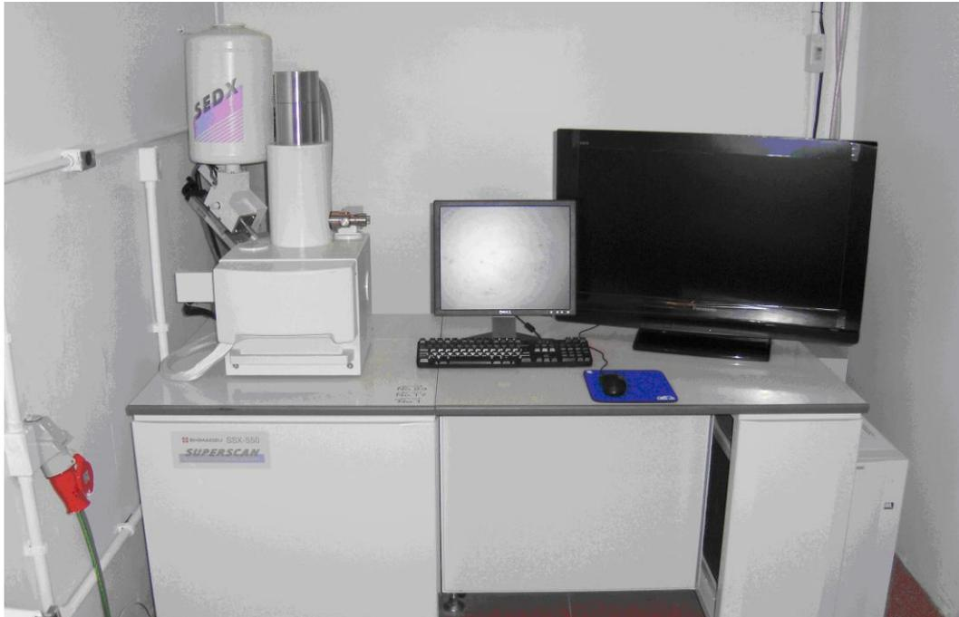
**Figura 15.** Modelo do microscópio eletrônico de varredura (MEV).
