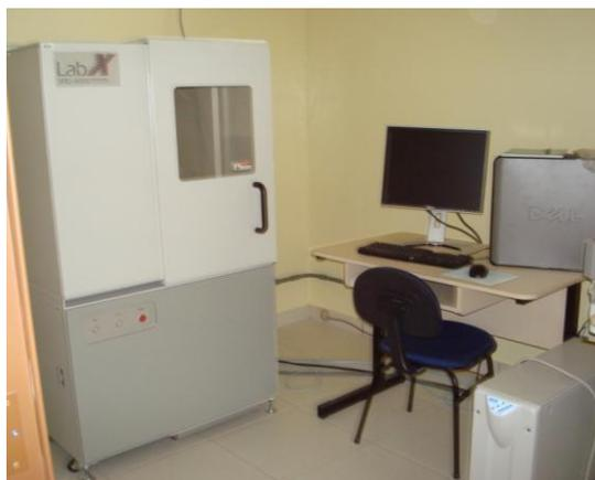
**Figura 14.** Equipamento do Difratorômetro de raios-X.
