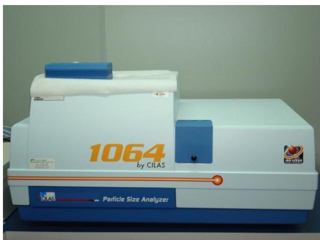
**Figura 10.** Equipamento do analisador de partículas, CILAS 1064<sup>73</sup>.
