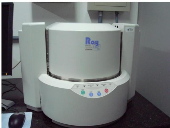
**Figura 13.** Equipamento espectrômetro de fluorescência de raios-X por energia dispersiva<sup>73</sup>.
