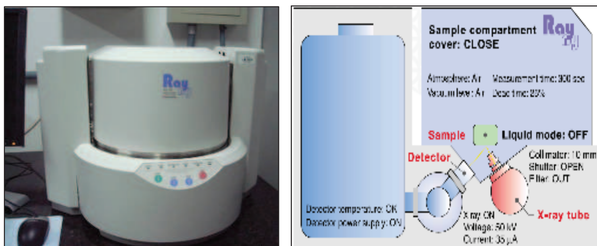
Fig. 3.7 – Equipamento EDX Ray Ny - EDX 720 ® + Esquema de Funcionamento (Fonte: própria).
