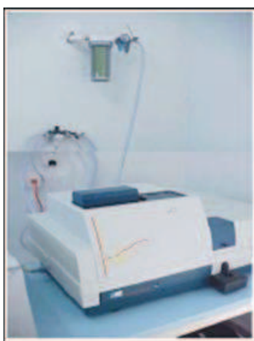
Fig. 3.4 – Granulômetro a laser Cilas1064-Líquido® (Fonte: Cilas® ).
