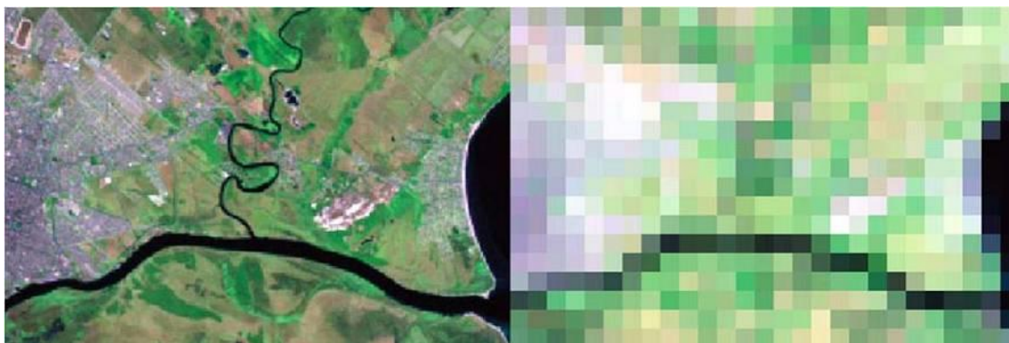
Figura 3.6: Similaridade entre grids celulares e pixels de imagens de satélite (diferentes resoluções para Pelotas, RS). Fonte: Polidori (2004).
