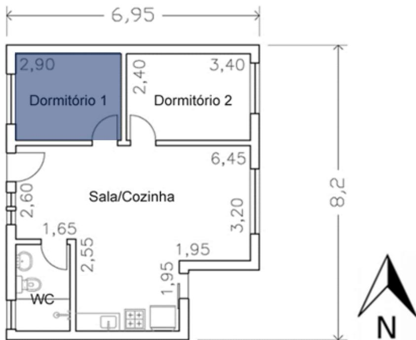
Figura 15 - Orientação do dormitório 1 para o dia típico de verão
