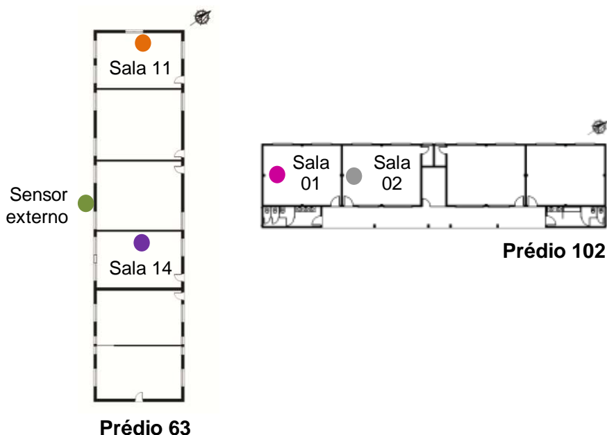
Figura 26 - Planta Baixa dos prédios 63 e 102, respectivamente, com a localização dos sensores.
